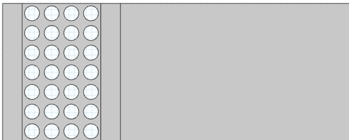
Figura 3.21. Modelo para ff=90\% (FEM)
