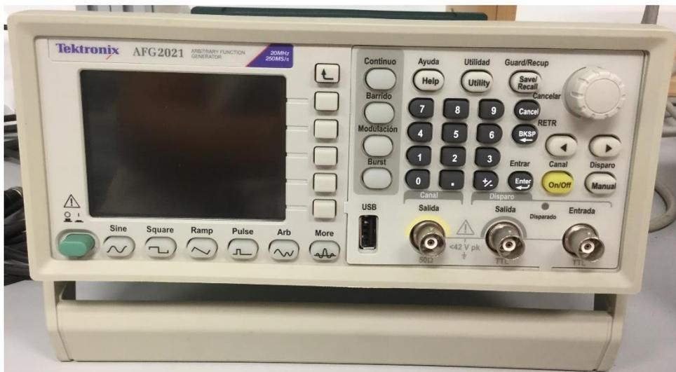
Figura 1: Generador de funciones
