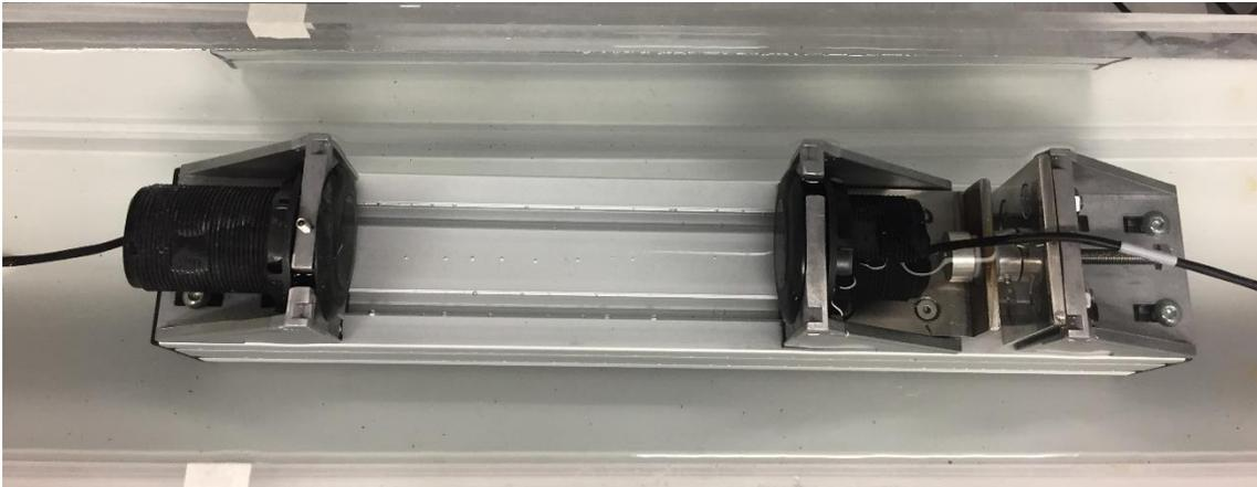
*Figura 16: Montaje dos transductores distintos*
