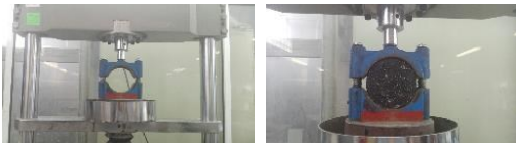
Figura 48. Equipo de ensayo Marshall
