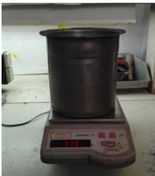
Figura 42. Recipiente con mezcla para realizar el ensayo de recuperación de betún
