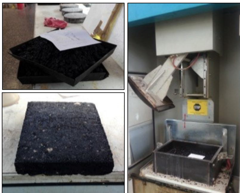
Figura 39. Preparación de probetas mediante compactador de placa
