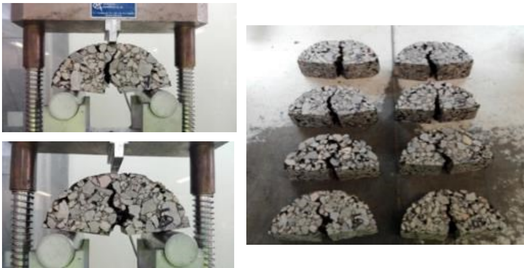
Figura 24. Ejemplo ensayo SCB para muestra SMA 16
