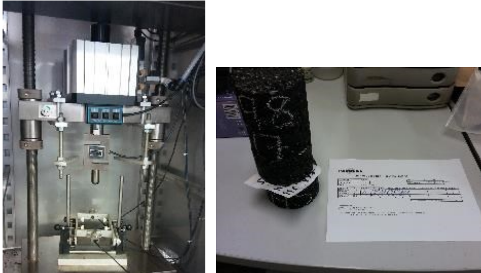
Figura 26. Equipo de ensayo y probetas para obtención de Módulos de rigidez
