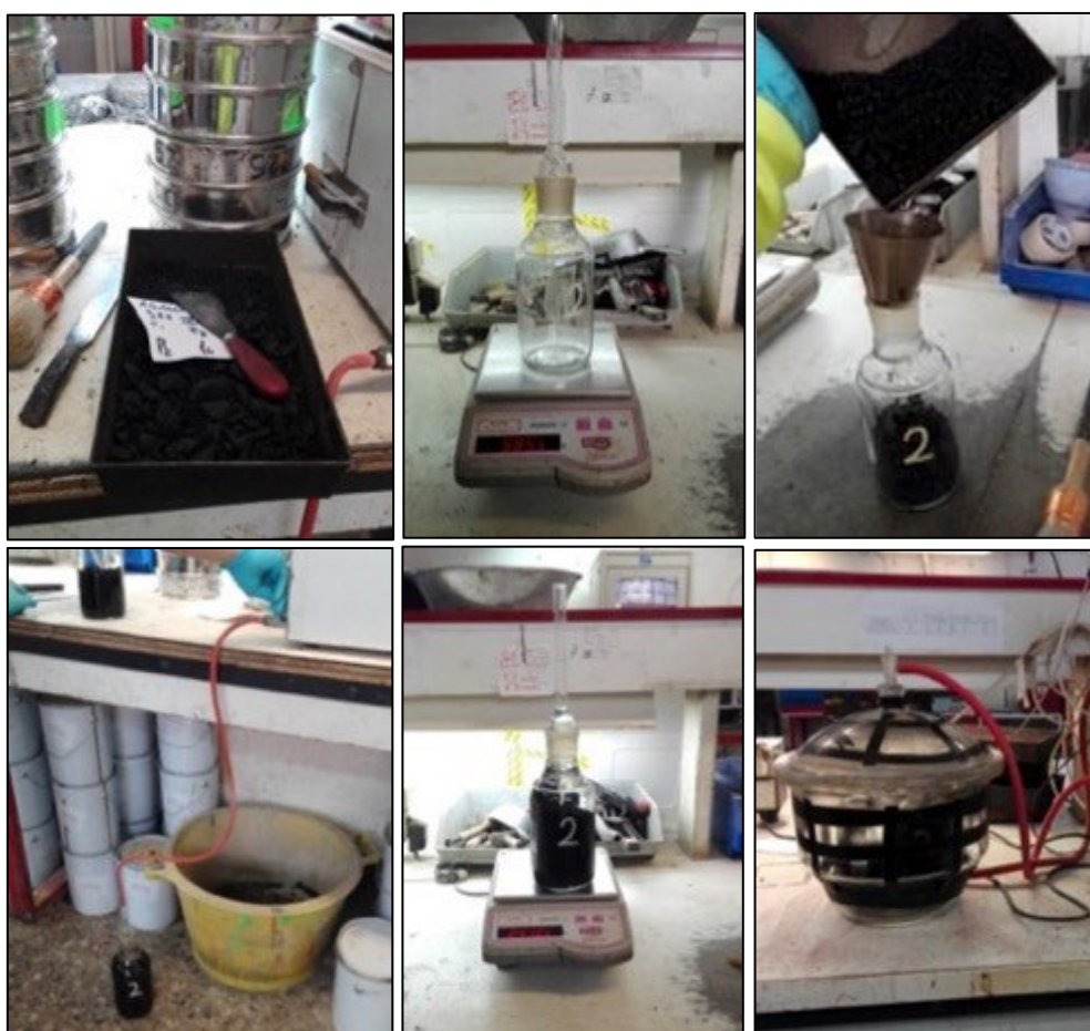
Figura 46. Realización del ensayo de densidad máxima
