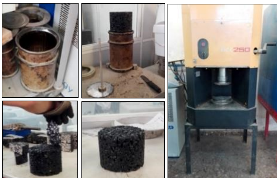
Figura 40. Preparación de probetas de 150 mm mediante compactador giratorio
