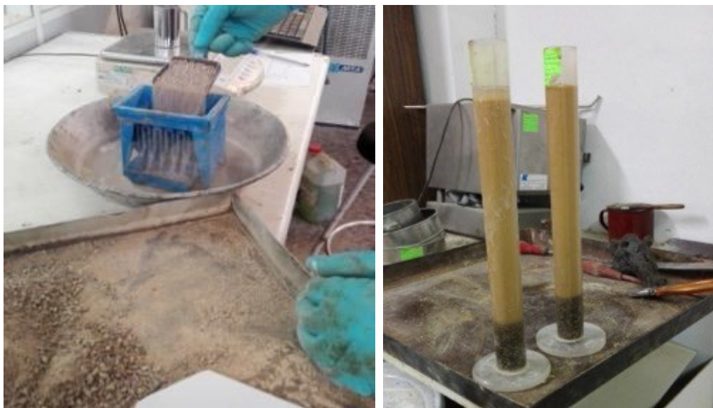
Figura 36. Ensayo del equivalente de arena
