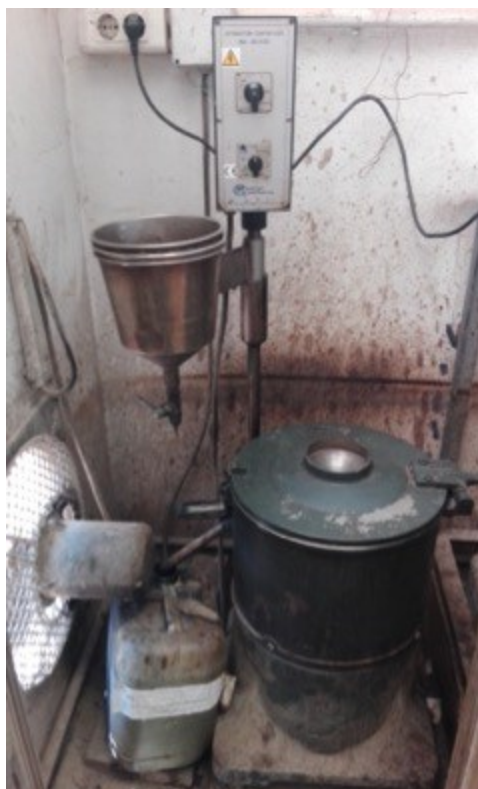
Figura 47. Equipo de recuperación de betún por centrifuga
