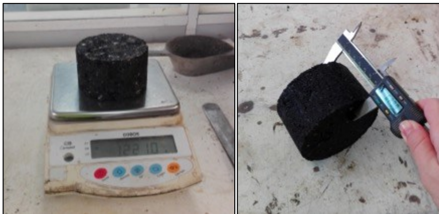
Figura 44. Densidad aparente según método geométrico. Probetas Marshall
