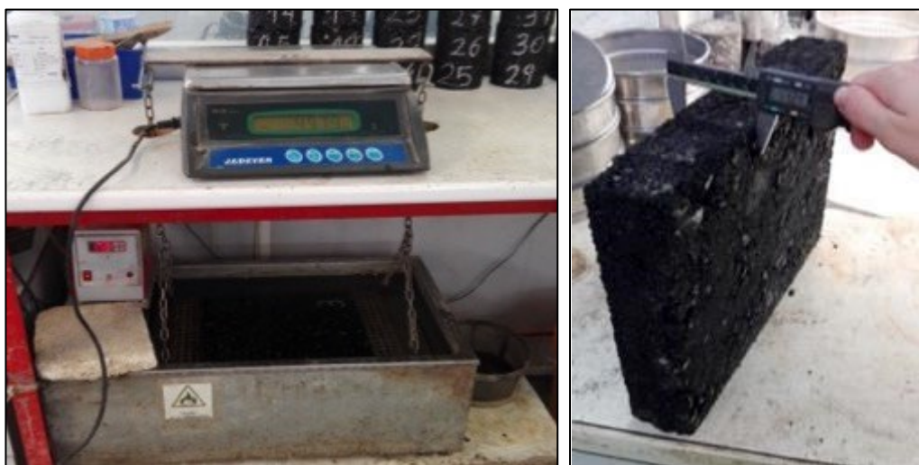
Figura 45. Densidad aparente según método geométrico. Probetas de pista
