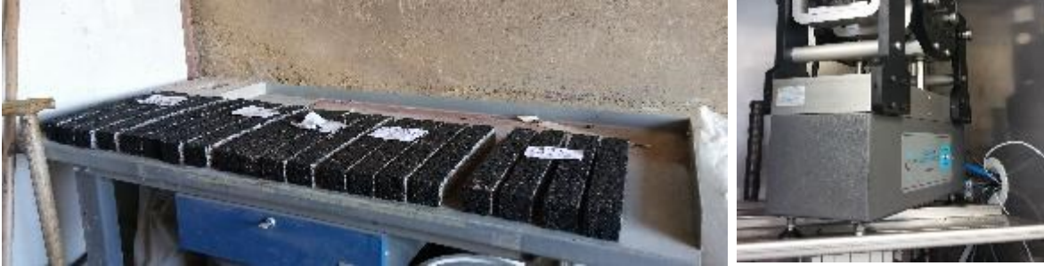
Figura 21. Probetas serradas y equipo de ensayo a fatiga
