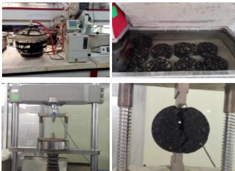
Figura 49. Ensayo de sensibilidad al agua
