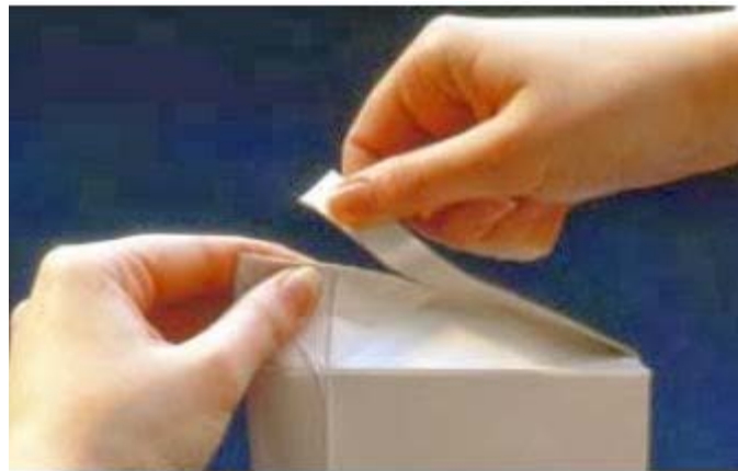
Figura 24. Ejemplo de sistema de apertura mediante líneas perforadas ( http://mgongarcia.blogspot.com.es )
