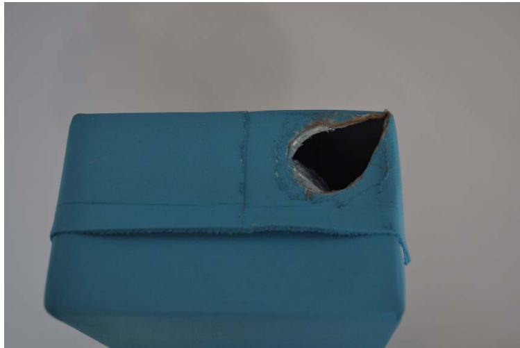
Figura 36. Orificio de vertido que llega hasta el vértice del envase. (Autor)
