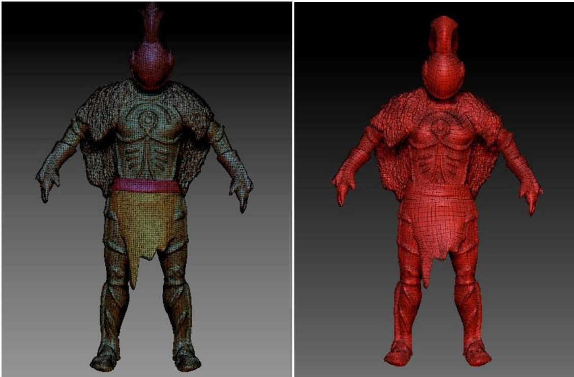
Figura 28. A la izquierda el modelo con más de ocho millones de polígonos y a la derecha con unos quinientos mil
