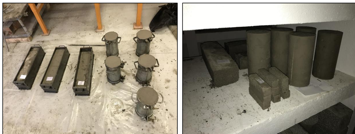
Figura 16: Moldes rellenos de las distinta amasadas de mortero y probetas desencofradas colocadas en cámara húmeda. Fuente: Propia.
