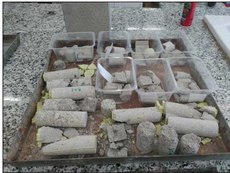
Figura 19: Testigo de mortero tras ensayos de compresión simple y brasileño. Fuente: Propia.
