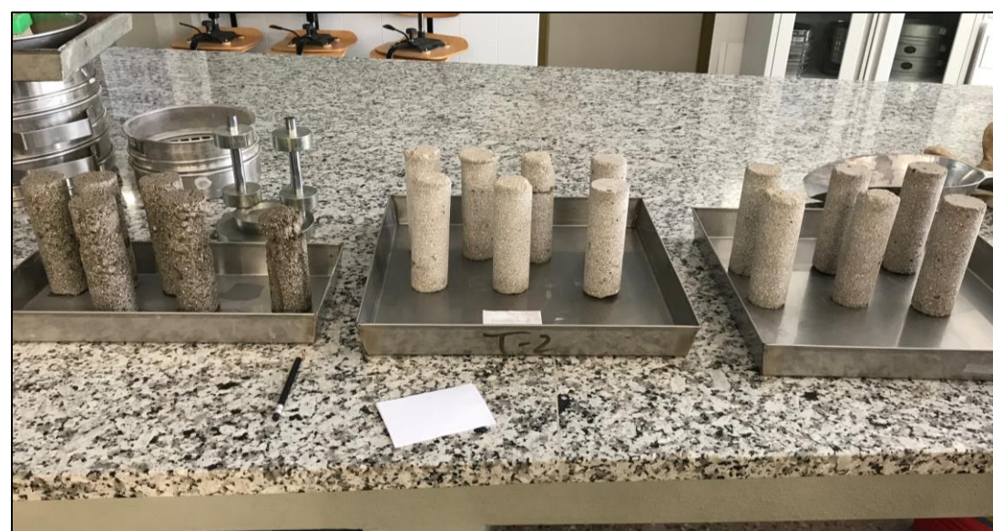
Figura 18: Testigos extraídos –Todas las amasadas. Fuente: Propia.
