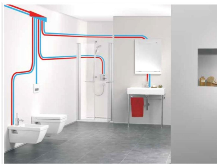
Figura 26. Instalación tipo de fontanería, 2017, materialescalefaccion.com
