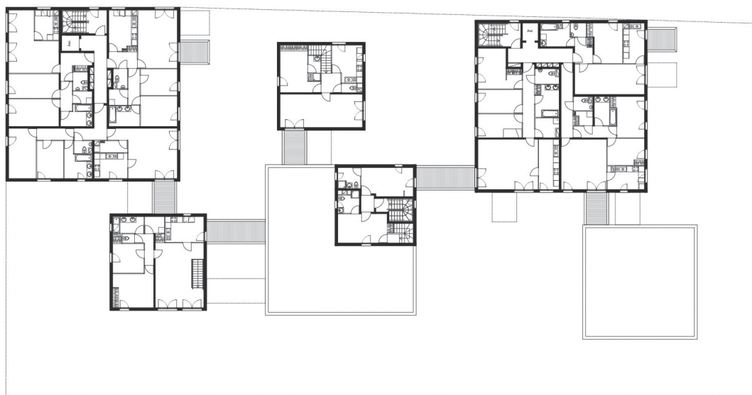
Figure 5. Plans des plots de l'opération « Les Brouets », Mantes la Ville, Hondelatte et Laporte, architectes (plan de l'agence). Appartement principal et studio associé : Chacun a un accès par un immeuble différent, ce qui empêche la surveillance des allées et venues du jeune adulte ou d'un ascendant, et garantit l'intimité.
