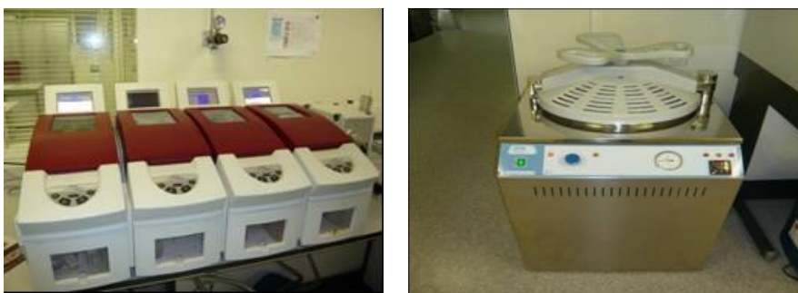
Figura 3.7: a) Autoanalizador de flujo continuo segmentado por aire y b) Autoclave
