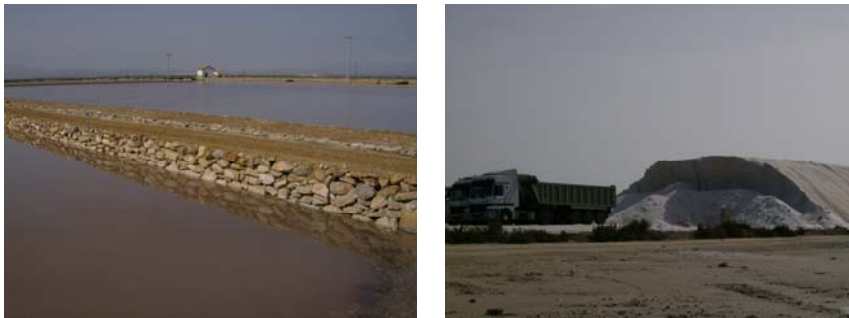
Figura 2.5: a) Estanques cristalizadores del circuito salinero de Bonmatí en Santa Pola y b) Pilas de sal
