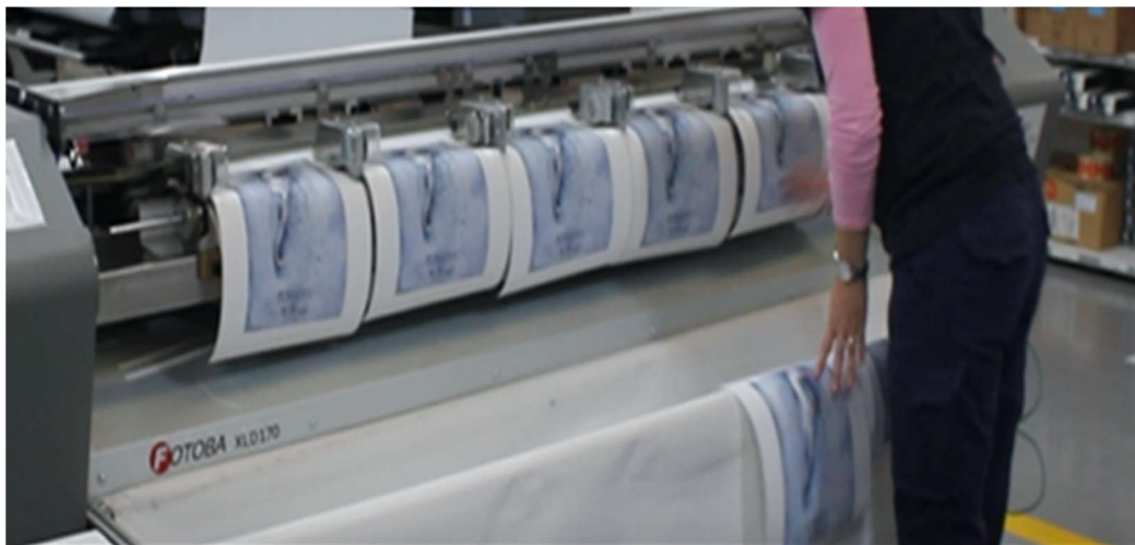
Figura 20: Operario muestra el proceso de la cortadora. Fuente: Elaboración propia.
