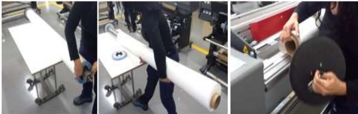
Figura 16: Operario muestra el proceso del paso del eje de la impresora al canuto con topes hacia la cortadora. Fuente: Elaboración propia.
