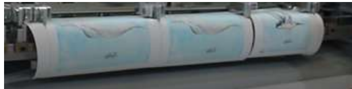
Figura 28. Muestra de mezcla de diferentes tamaños en la misma fila de impresión y corte provocando reprocesados. Fuente: Elaboración propia.
