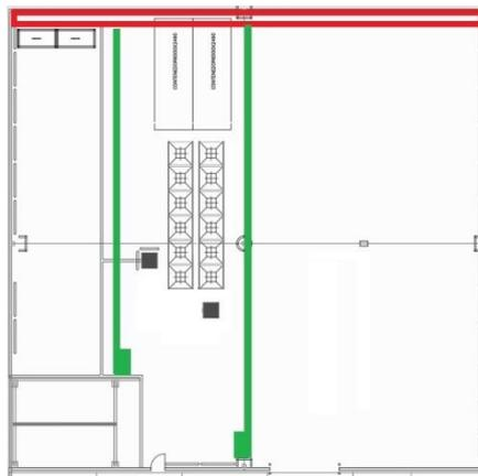
Figura 28: *Lay-out* de la Nave de Virutas, donde se indica el foso ciego en rojo y los canales de control con sus arquetas de registro en verde.
