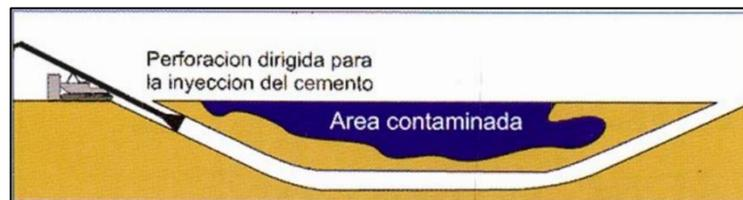
Figura 3: Sistema de inyección de la lechada de cemento.
