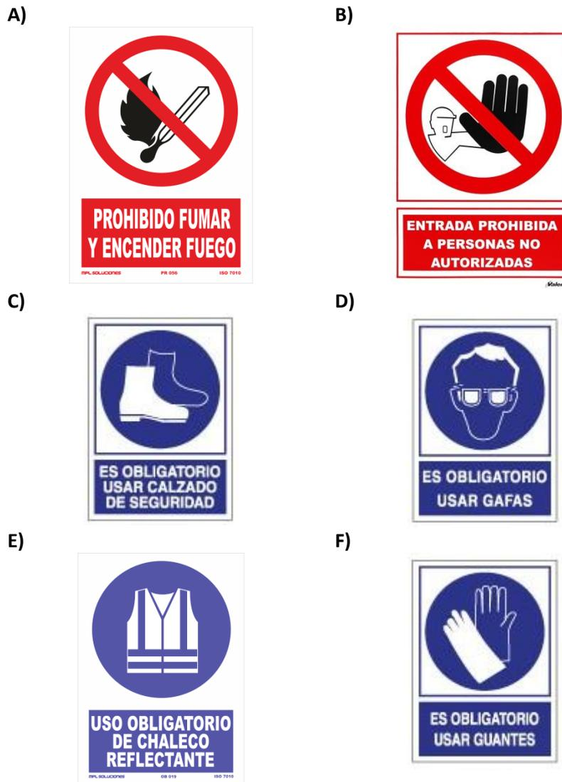
Figura 5: A) y B) Señales de prohibición “Prohibido fumar y encender fuego” y “Entrada prohibida a personas no autorizadas”, respectivamente. C), D), E) y F) Señales de obligación “Es obligatorio usar calzado de seguridad”, “Es obligatorio usar gafas”, “Uso obligatorio de chaleco reflectante” y “Es obligatorio usar guantes”, respectivamente.
