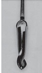
Figura 14: Sonda de Edelman. Fuente: Guía IHOBE.
