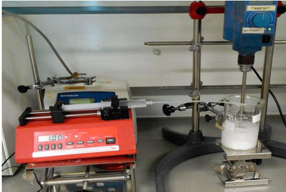
Figura 7. Montaje para la fabricación de las microesferas de PLLA
