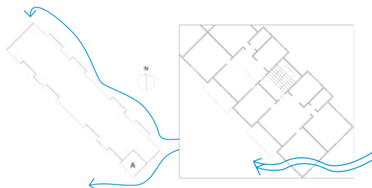
165. Esquema de flujo de aire en el interior y exterior de la habitación A. (EP)
