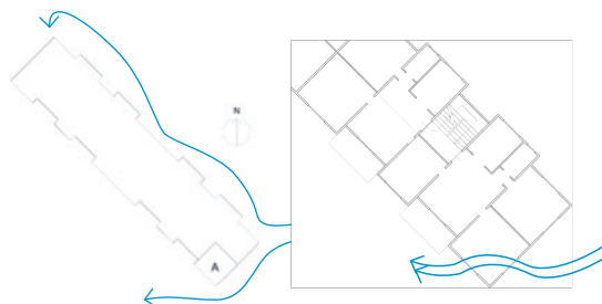
176. Esquema de flujo de aire en el interior y exterior de la habitación A. (EP)
