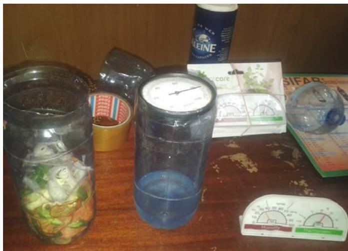
*Figura 170. Higrómetros para medir la actividad del agua (Lozano, I. 2013)*
