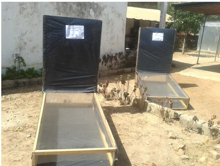
*Figura 162. Primeros dos deshidratadores solares montados en las instalaciones de la APFG en Burkina Faso (Lozano, I. 2013)*
