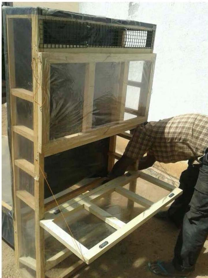
Debido a las altas temperaturas, la parte posterior se ha construido con puertas y no directamente con plástico unido con velcro a la madera, puesto que acaba despegándose.
