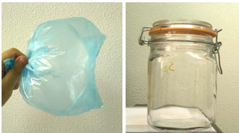
*Figura 149. Bolsa de triple capa y frasco de cierre hermético para medir la actividad del agua en el alimento deshidratado*
