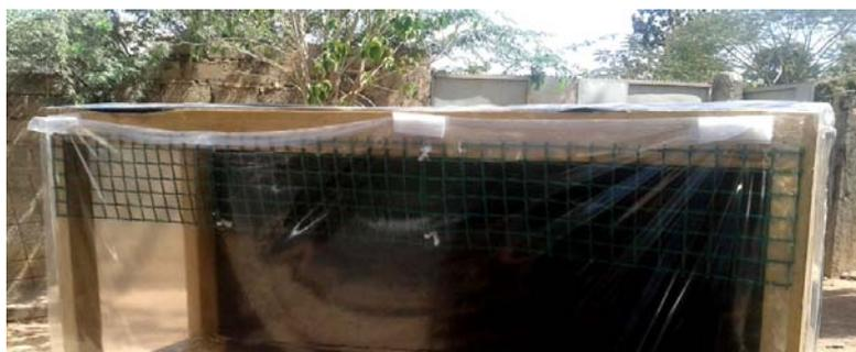
Figura 175. Velcro fijando el plástico a la estructura del equipo (Lozano, I. 2013)
