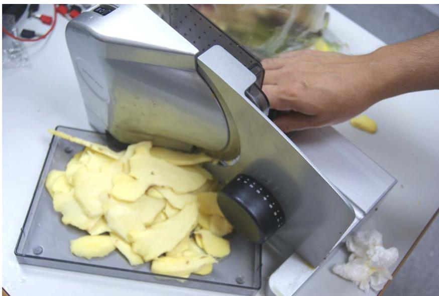
*Figura 254. Cortadora eléctrica para obtener láminas de alimentos con un grosor uniforme, aplicada a jengibre*
