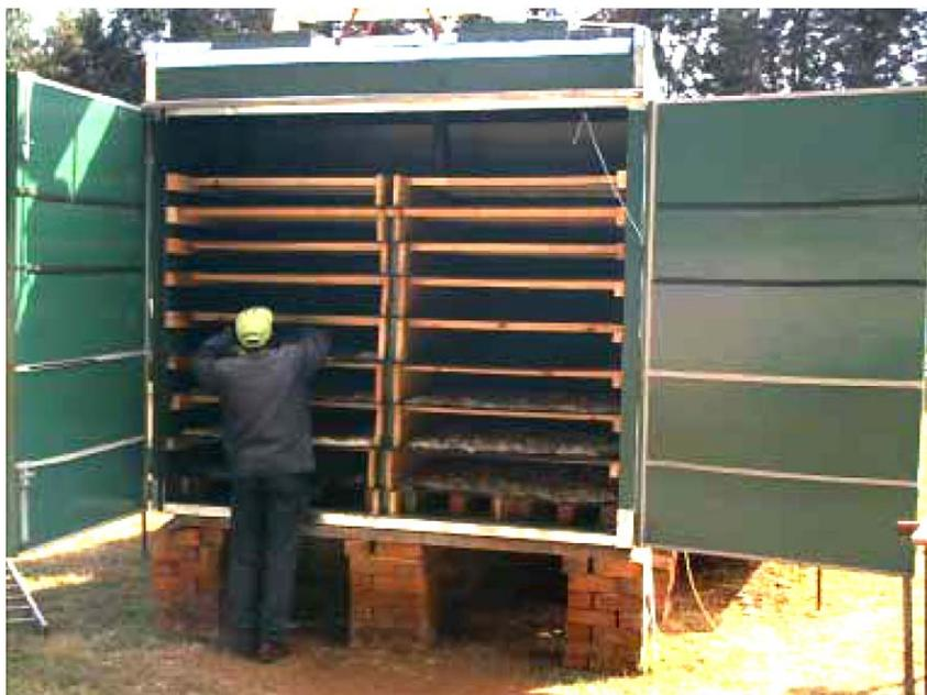
Figura 20. Deshidratadores de gabinete construido en Zimbawe (Weiss, W. 2012)
