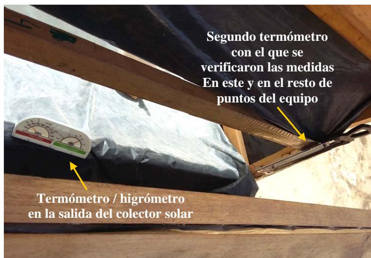
*Figura 195. Posición a la salida del colector solar de los dos tipos de termómetros utilizados para hacer las medidas (Valero, J. 2016)*
