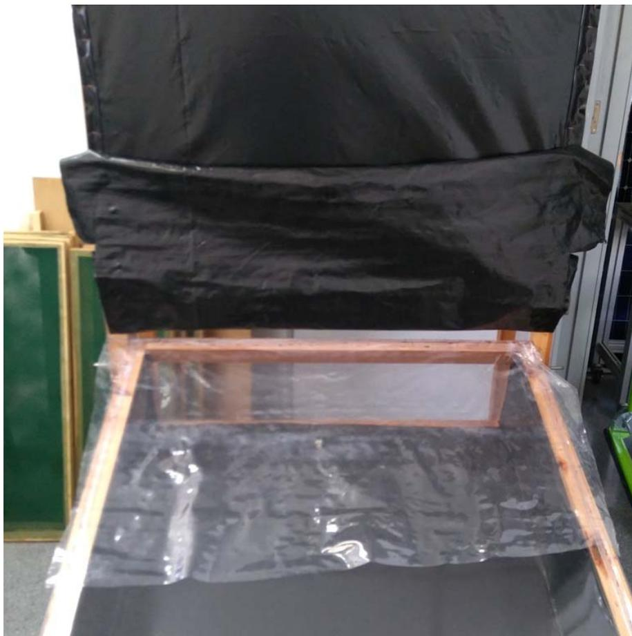
*Figura 250. Excedentes de plásticos del colector y la cámara de secado, antes de ser enrollados uno sobre otro*
