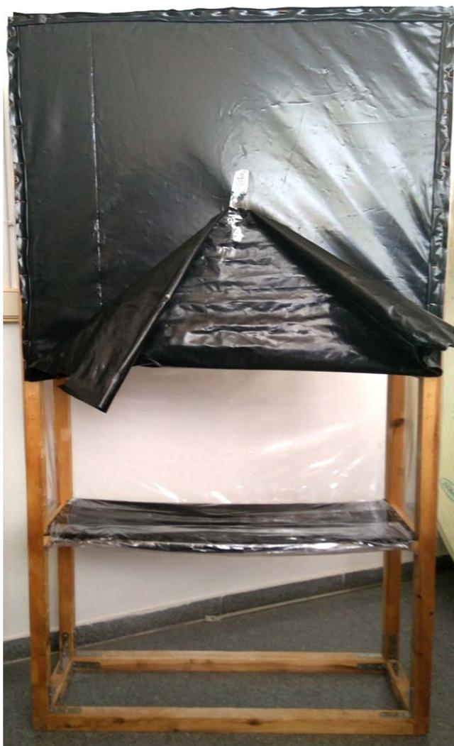
*Figura 55. Vista frontal de la cámara de secado con el excedente de plástico negro*
