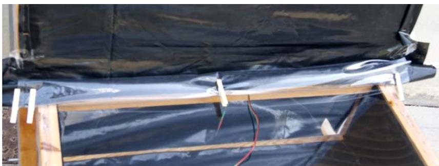
*Figura 54. Detalle de la unión de los plásticos de la cámara de secado y del colector*
