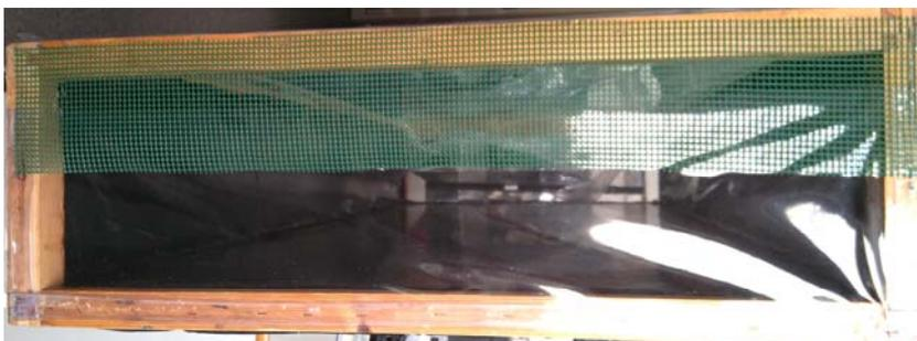
*Figura 52. Frontal del colector, cerrado con rejilla y plástico transparente*
