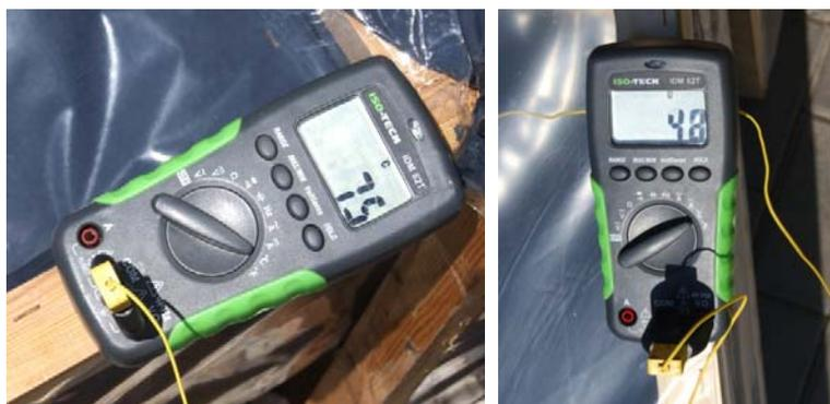
Figura 267. Iso-Tech IDM 62T midiendo la temperatura en el interior del colector solar, por medio de una sonda que se introduce hasta el punto deseado
