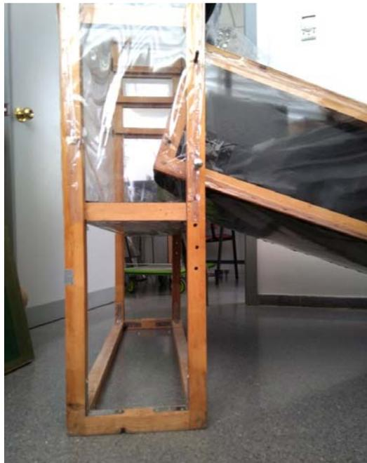
*Figura 253. Modificación de la inclinación del colector, elevándola a veinte grados, aprovechando el cambio a utilizar dos pasadores*
