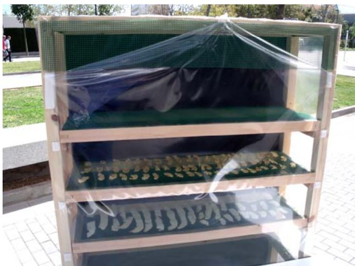
Figura 81. Cámara de secado cerrada con velcro en el deshidratador de 2013
