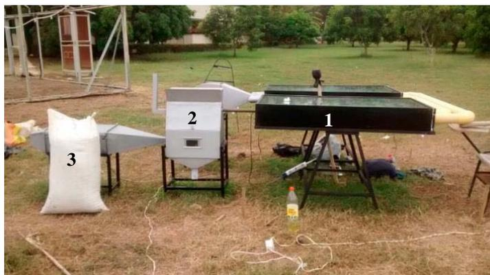
Figura 29. Deshidratador híbrido compuesto por: Colectores solares (1), quemador de biomasa (2) y secador (3) (Torres Gallo, R. 2017)
