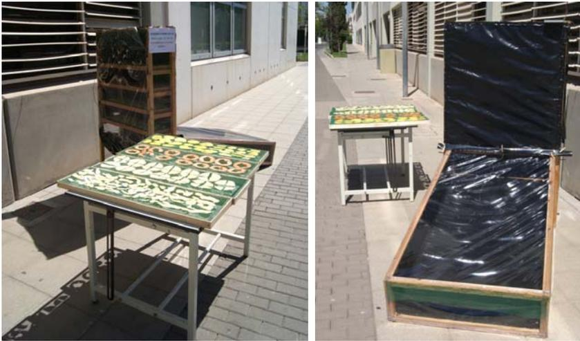
*Figura 268. Secado directo al sol y mediante el deshidratador diseñado*
