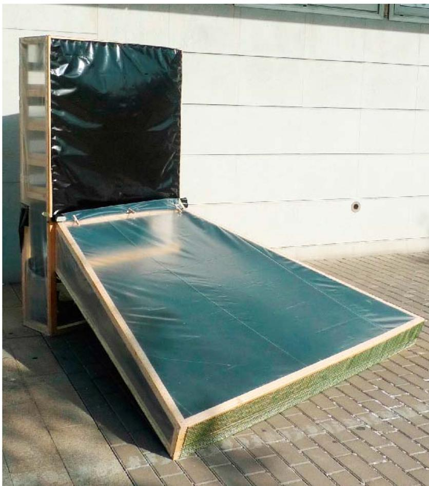
*Figura 236. Nuevo deshidratador diseñado a partir de un TFG (Moragues, B. 2016)*
