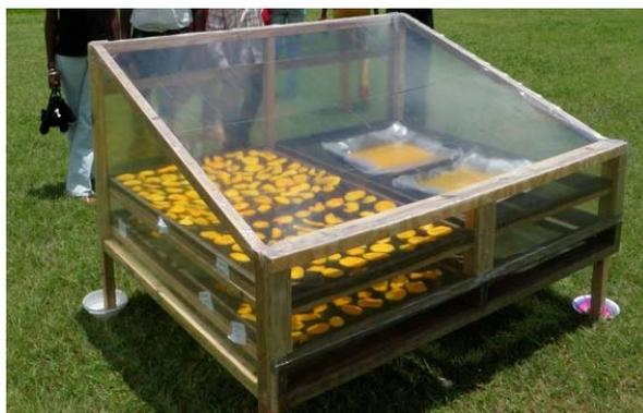
*Figura 12. Variante del deshidratador genérico con exposición directa al sol*
