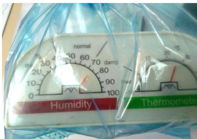
Figura 152. Higrómetro introducido en una bolsa junto a sal común saturada en agua, para su calibrado
