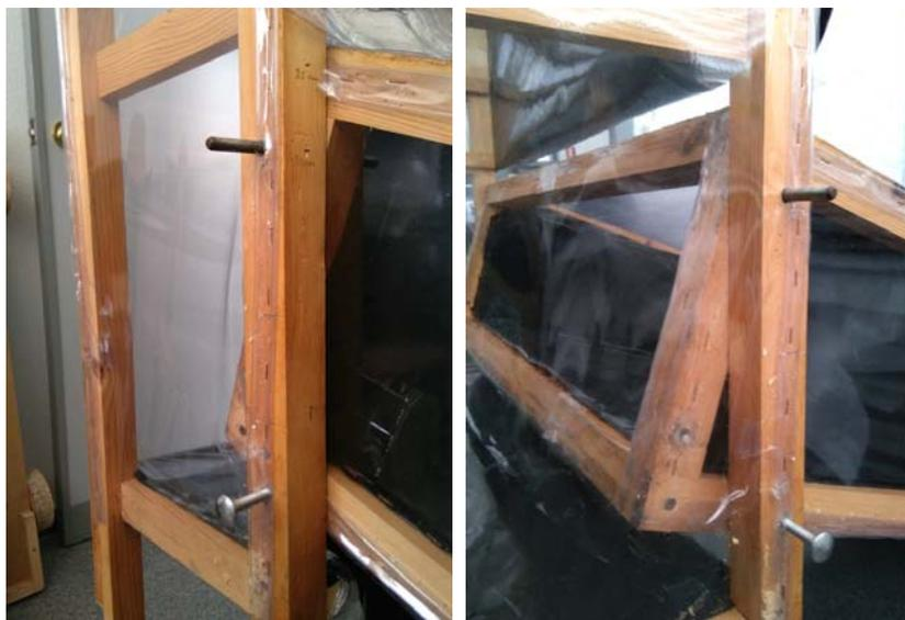
*Figura 252. Unión del colector y la cámara de secado mediante dos pasadores, para dar más estabilidad al deshidratador*
