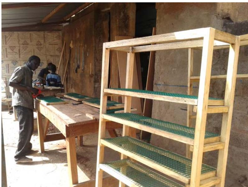
*Figura 159. Primer deshidratador con las bandejas montadas y operarios trabajando sobre las bandejas de un segundo deshidratador (Lozano, I. 2013)*
