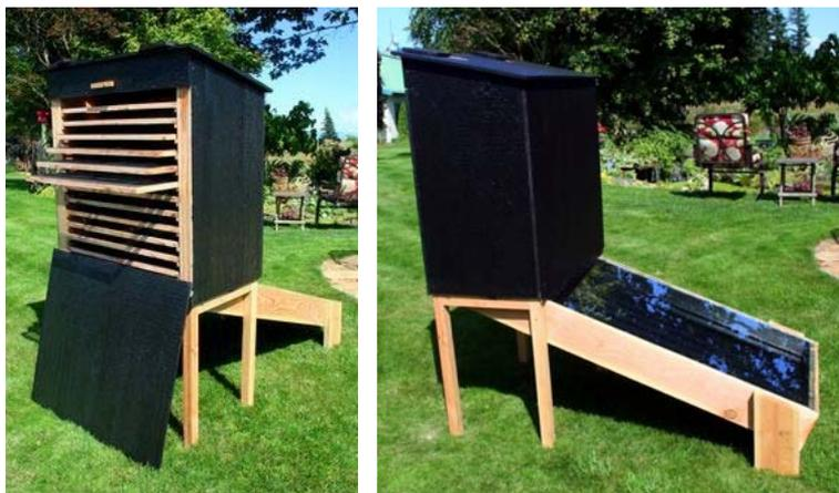
*Figura 24. Dos vistas de un deshidratador indirecto (<https://www.pinterest.se/tuskenbane/dehydrator-plans/>)*
