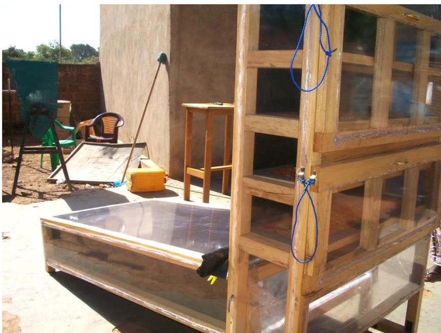
Figura 204. Deshidratador construido en Arbolle a final de 2016 (Márquez, M. N. 2016)
