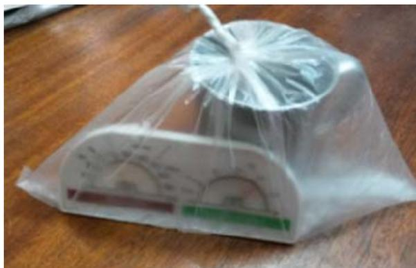
*Figura 185. Calibración de un punto de higrómetros de bajo coste realizada en Burkina Faso en enero de 2015 (López, D. M. 2015)*
