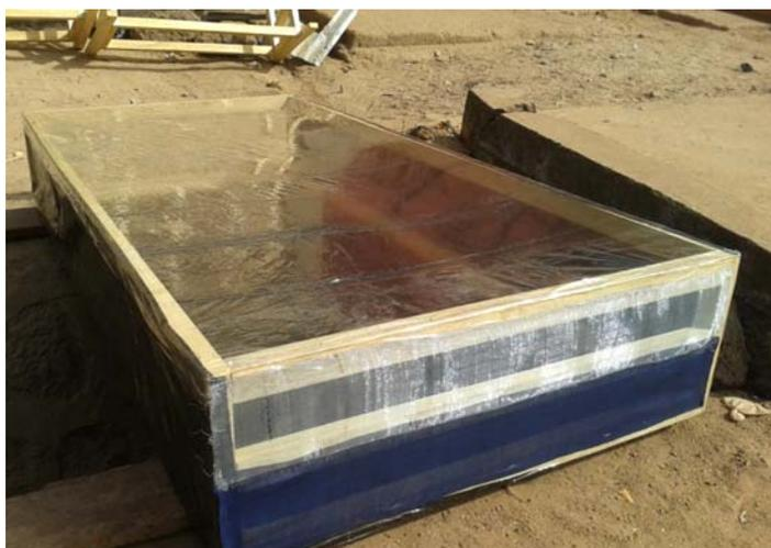
*Figura 178. Mosquitera colocada en la parte frontal del colector para evitar la entrada de arena o materiales arrastrados por el aire (López, D. M. 2015)*
