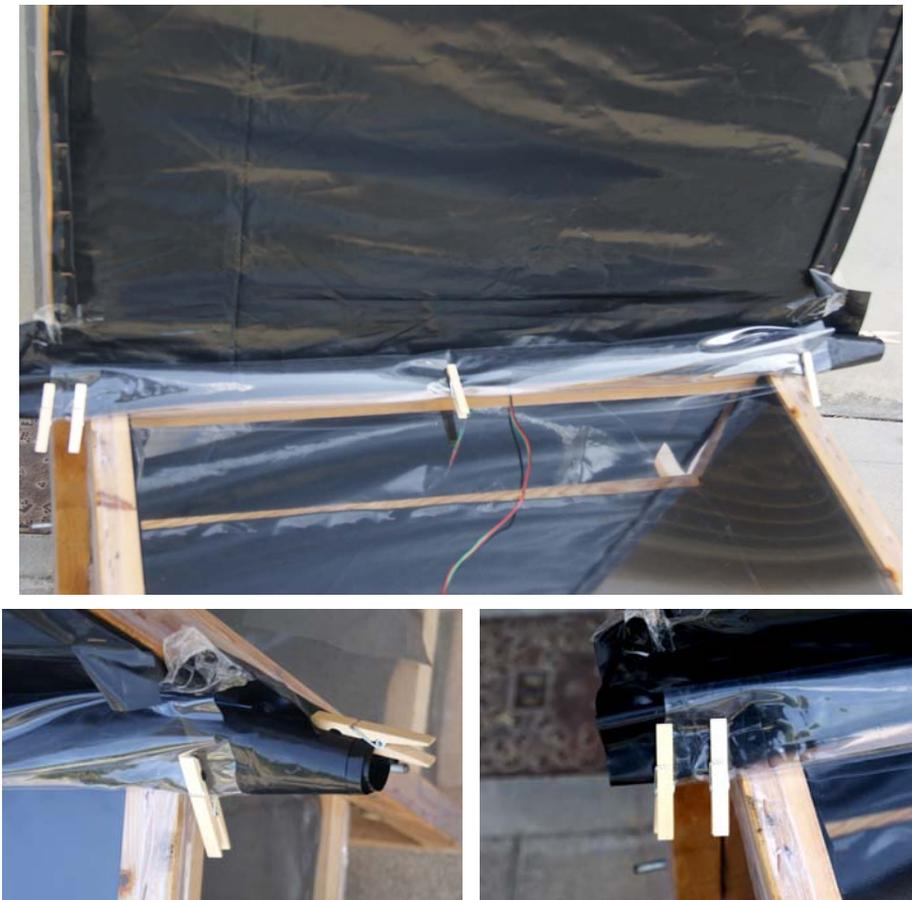
*Figura 249. Unión de los plásticos del colector y la cámara de secado, enrollados uno sobre otro y fijados mediante pinzas*
