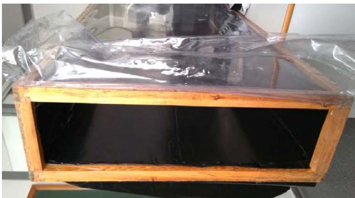
*Figura 53. Zona de salida del aire calentado en el colector*
