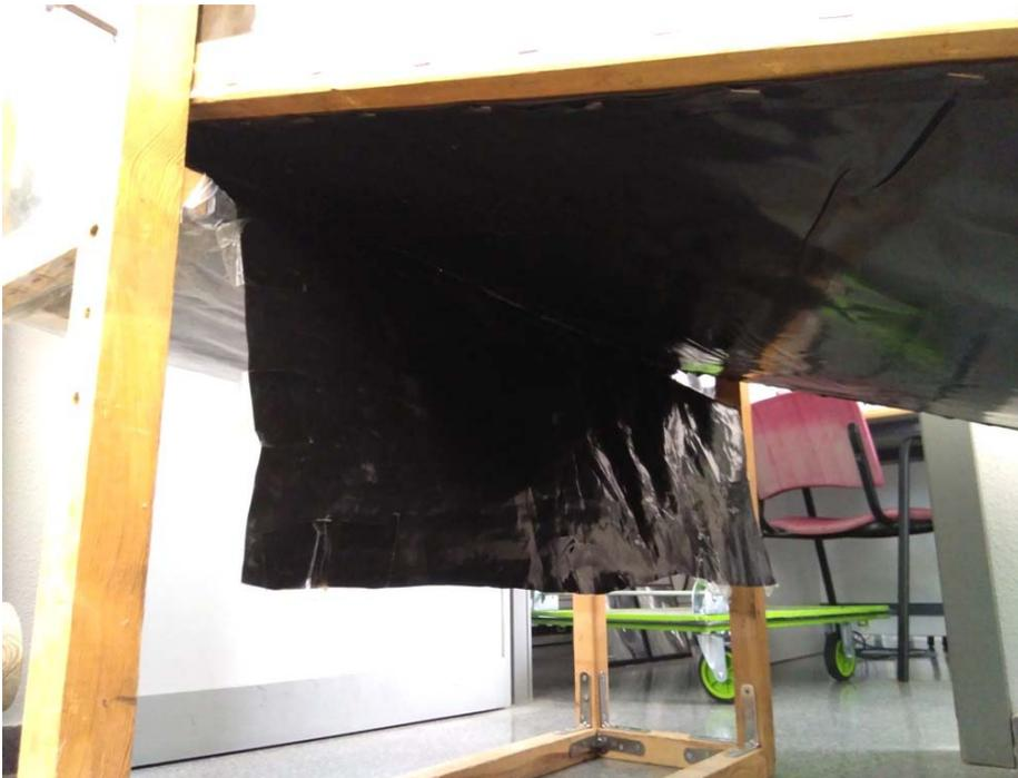
*Figura 251. Excedente de plástico negro del colector solar, que se une con cinta adhesiva al cierre inferior de la cámara de secado*
