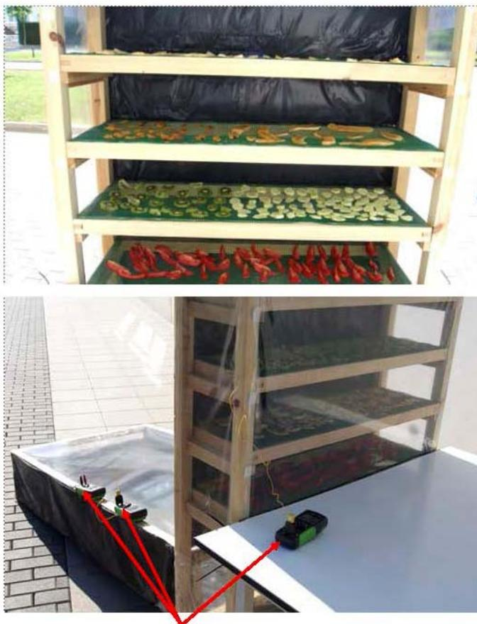
Aparatos de medida para tomar temperaturas y radiación solar que incide sobre el plano del colector.
