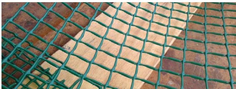
*Figura 177. Rejilla con un calibre demasiado elevado utilizada en la fabricación de los deshidratadores en Burkina Faso (Lozano, I. 2013)*
