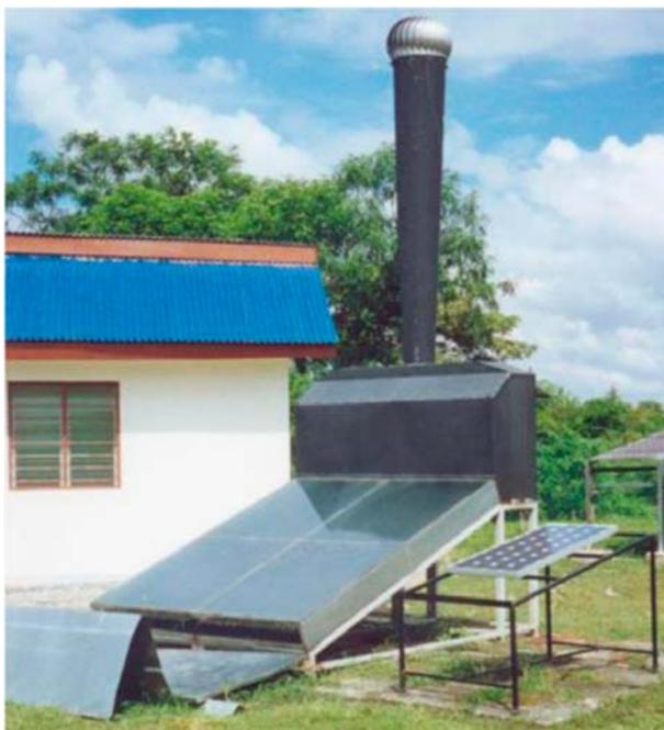
*Figura 31. Deshidratador híbrido más complejo que incorpora placas solares de calentamiento y fotovoltaicas (Fudholi, A. 2015)*
