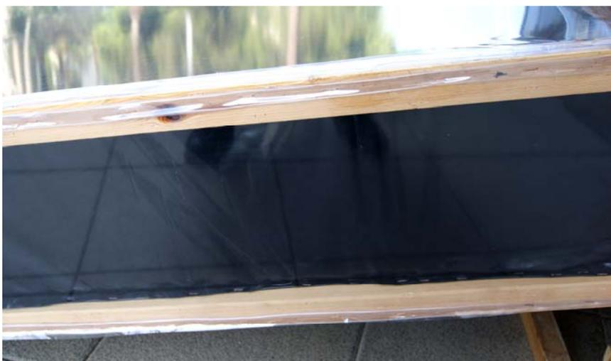
*Figura 245. Doble capa de plástico, transparente y negro, en el lateral del deshidratador*
