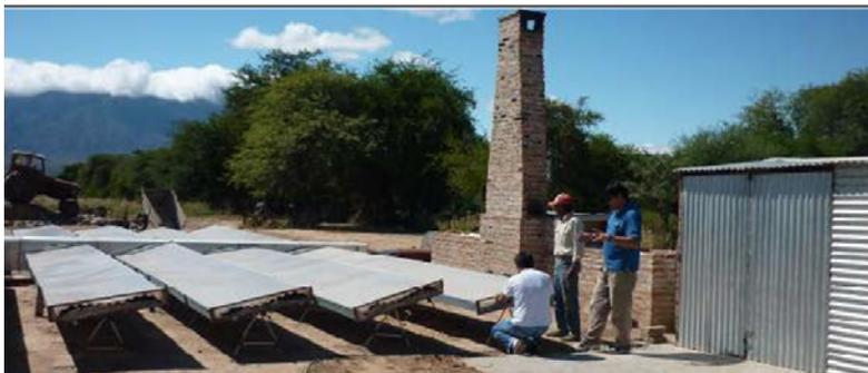
*Figura 28. Esquema de un deshidratador híbrido industrial y vista de sus colectores solares (Durán, G. J. 2010)*
