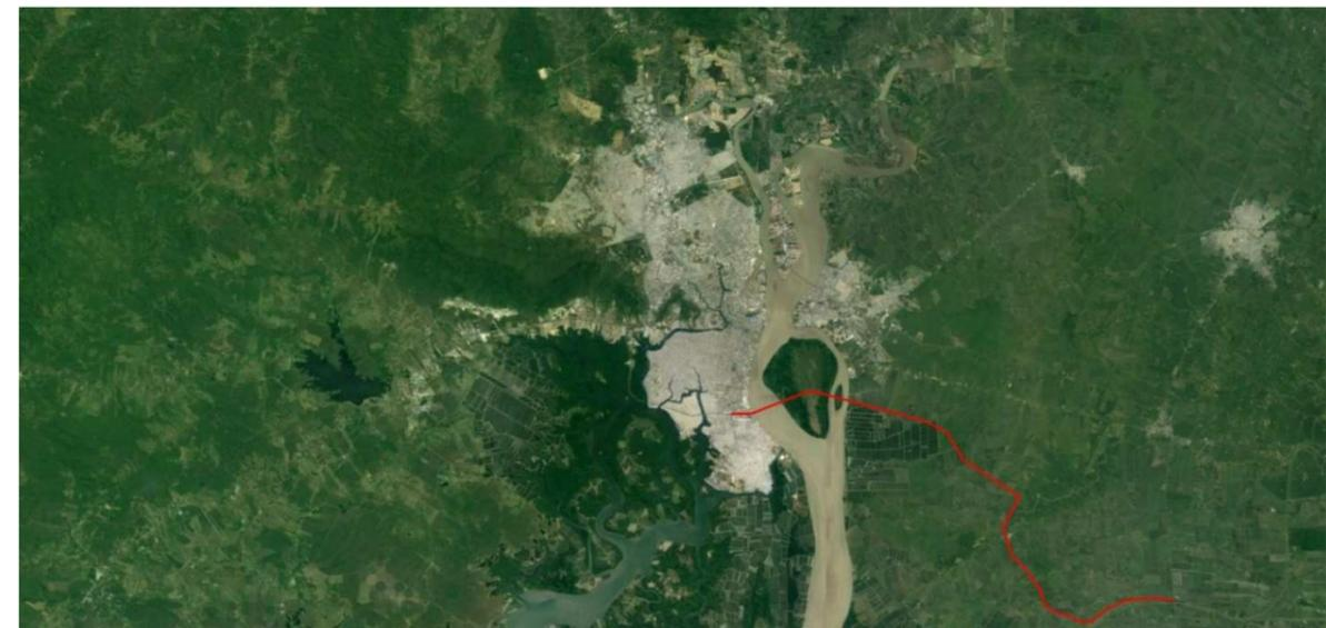
Figura 47: Trazado tentativo de Alternativa "E1" implantado en imagen satelital
