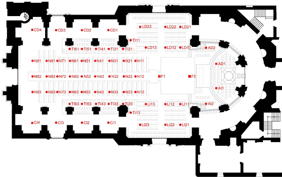
Figura III.7. Posiciones de fuentes y receptores para las medidas en la Basílica en la planta baja, para el Misteri.
