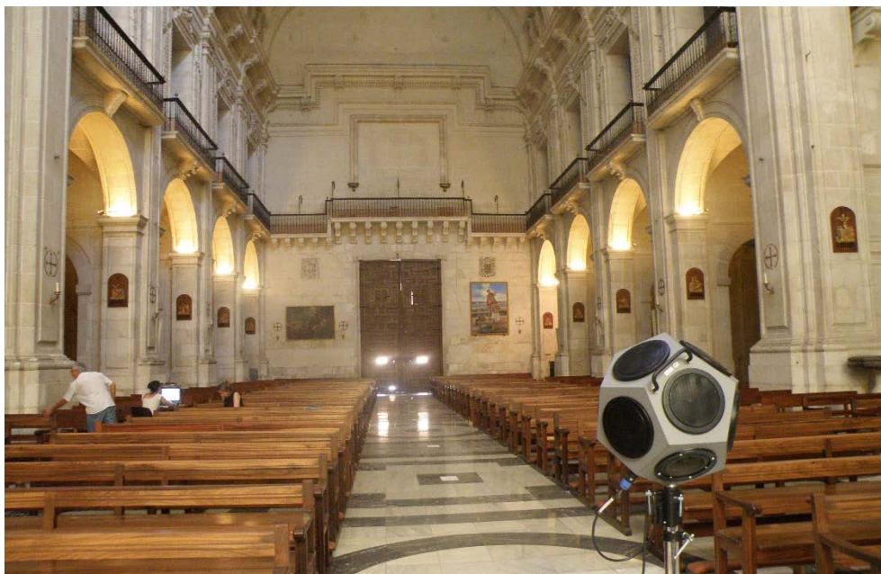
Figura III.4. Campaña de medidas en la Basílica con la figuración propia del culto.
