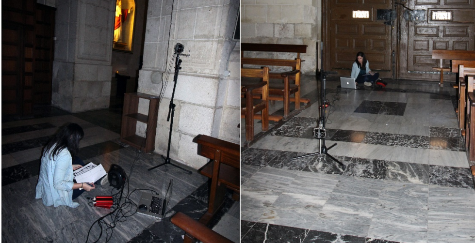
Figura IV.2.4.14. Campaña de medidas de absorción in situ
