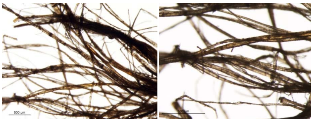
Figura 29. Microfotografías de una muestra de fibra SJ13, luz transmitida polarizada, \times 20-40 .
