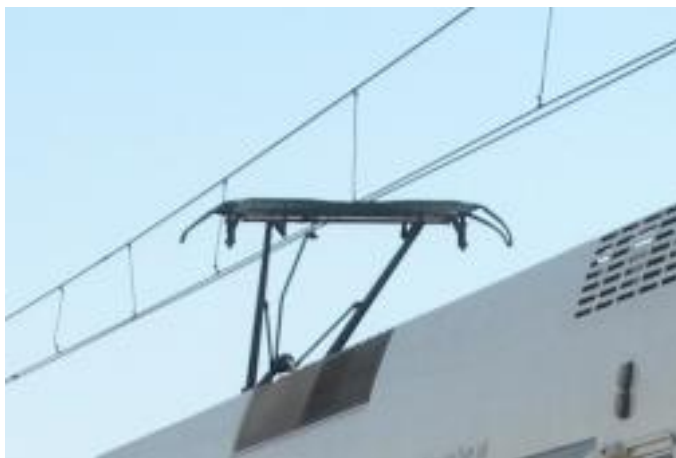
Fig. 11. Pantógrafo de tren serie 4300 de vossloh de Metro Valencia.
