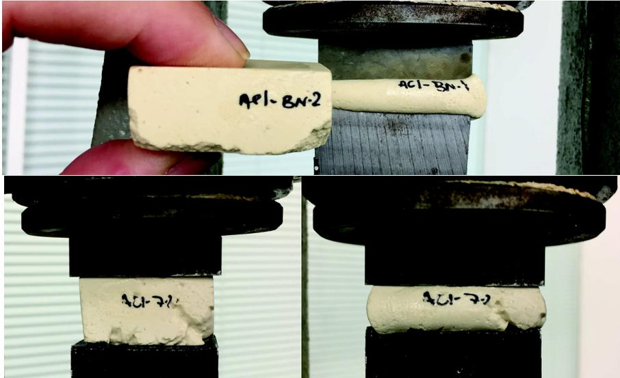
Imagen 8.18. Ensayo de compresión de las masillas de Acril® 33: AC-BN y AC-7 antes y después de la realización del ensayo.
