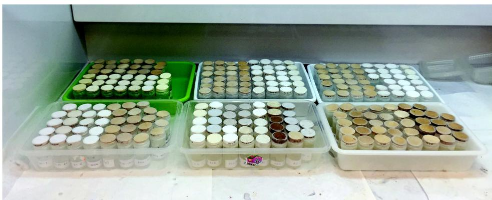
**Imagen 7.61. Ensayo de permeabilidad al vapor de agua.**
