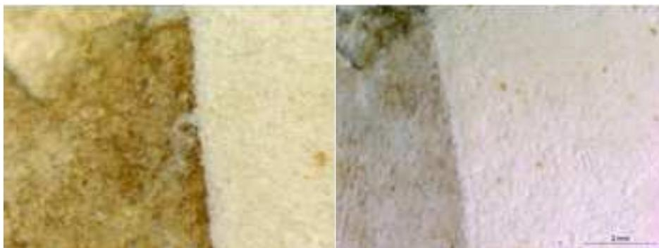
**Imagen 6.7. Masilla MH-P20. Detalle de fotografías realizadas en lupa a x8 aumentos. Izquierda: muestra sin envejecer; Derecha: después de la radiación UV**
