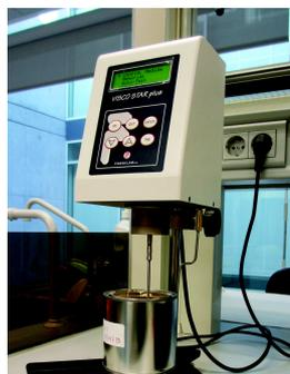
**Imagen 5.3. Proceso medición de viscosidad.**
