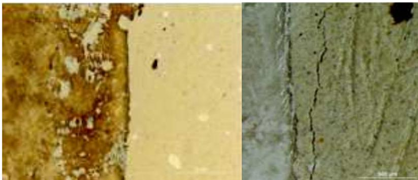
**Imagen 6.3.** Estuco de cera receta I76 pigmentada. Izquierda: Detalle de fotografías a x8 de la muestra sin envejecer; derecha: detalle a x16 de las fisuras después de 240 h exposición UV.
