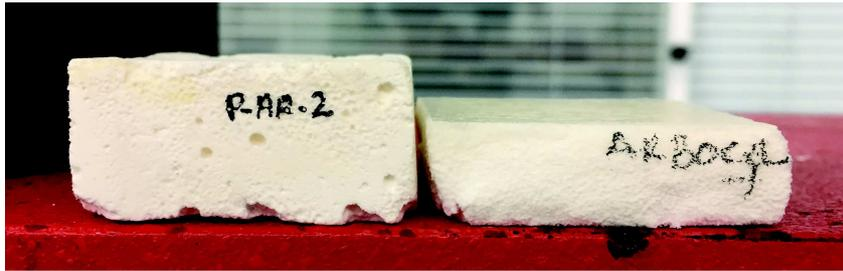
Imagen 8.16. Compresión de la masilla Paraloid<sup>TM</sup>B72 + Arbocel<sup>TM</sup> BWW 40 (PB72+AB).
