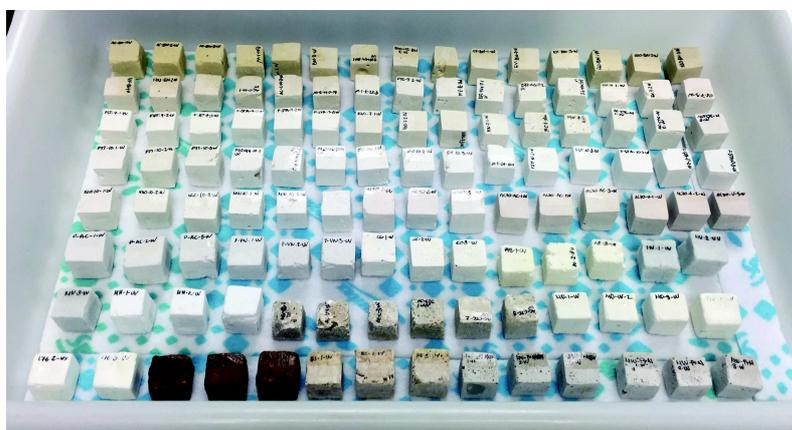
Imagen 7.24. Ensayo de absorción por capilaridad
