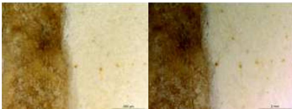
**Imagen 6.10. Masilla MH-P25. Detalle de fotografías realizadas en lupa a x8 aumentos. Izquierda: muestra sin envejecer; Derecha: muestra después de dos ciclos completos de humedad y temperatura.**
