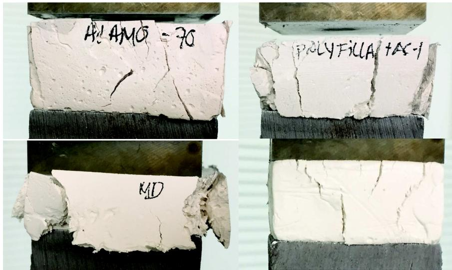
Imagen 8.14. Ensayo de compresión de las muestras de escayola Al70, Polyfilla<sup>®</sup> interior, Modostuc<sup>®</sup> y Estuco de cera I76.
