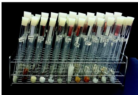
Imagen 9.2. Ensayo Oddy Test
