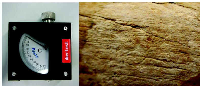
**Imagen 8.1. Izquierda: Medidor de dureza Shore C. Derecha: marcas de medición material óseo**
