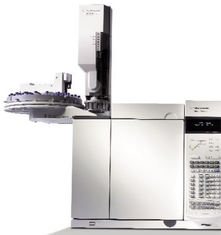
Figura 6.5. Cromatógrafo de gases Agilent 7890A.
