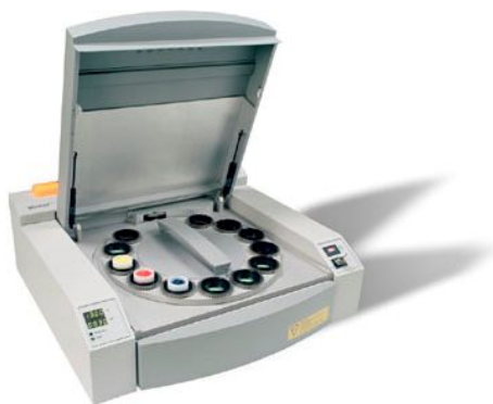
Figura 6.7. Equipo MiniPal 4 empleado para las medidas de Fluorescencia de rayos X.
