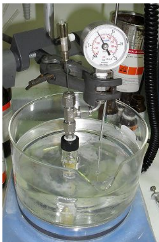
Figura 6.4. Reactor empleado para la hidrogenación de 1,5 COD.
