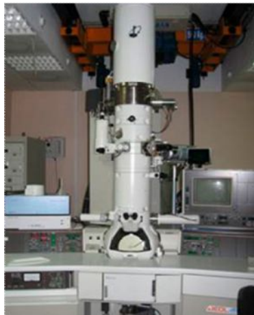
Figura 6.9. Equipo JEOL 2010F empleado para las medidas de microscopía electrónica.
