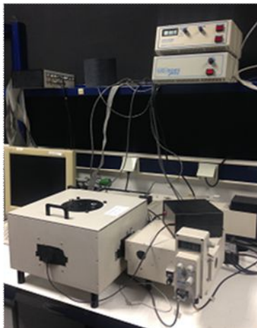
Figura 6.11. Espectrofotómetro LPS-220B utilizado para las medidas de fluorescencia.
