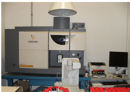
Figura 6.6. Equipo Varian 715-ES empleado para las medidas de ICP.
