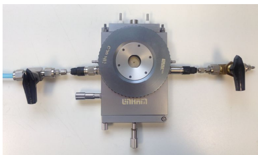
Figura 6.15. Celda Linkam FTIR 600.
