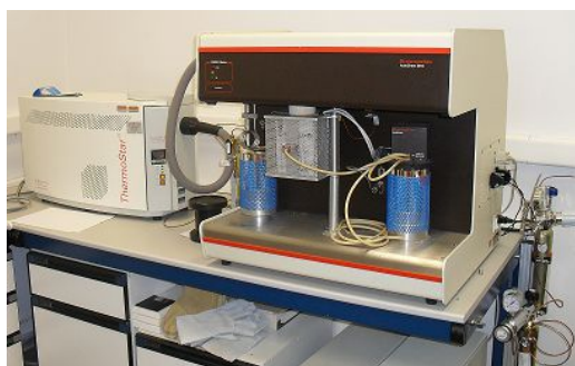
Figura 6.8. Equipo Auto Chem 2910 utilizado para las medidas de TPR.
