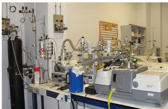
Figura 6.13. Imagen del equipo Nicolet 8700 y del sistema de vacío/presurización acoplado a él.
