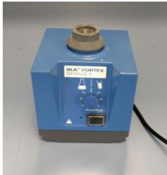
Figura 72. Imagen del Vórtex empleado en el procedimiento experimental para la realización de la emulsión.
