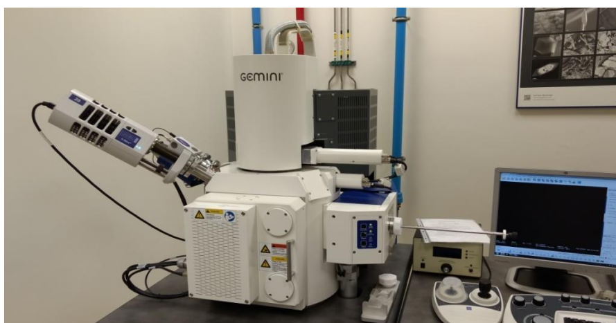
Figura 75. Imagen del microscopio SEM empleado en la obtención de las fotos de las membranas de electrospinning y los films de solvent casting .
