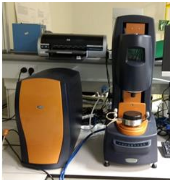
Figura 79. Imagen del reómetro empleado en el procedimiento experimental del ensayo de reometría.
