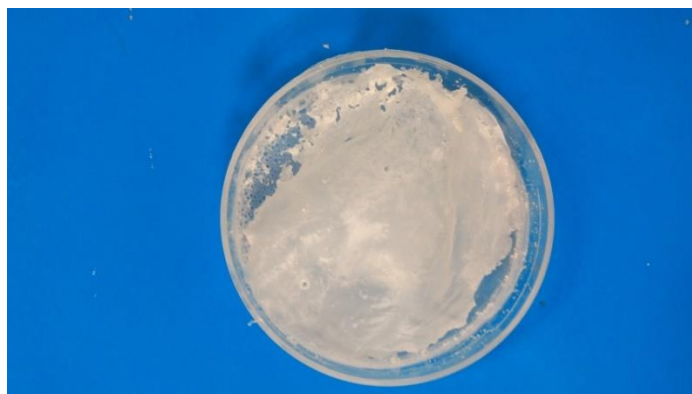
Figura 26. Imagen de la membrana de solvent casting realizada a partir de la fase polimérica formada por PLLA al 7% disuelto en una disolución de cloroformo - acetona.
