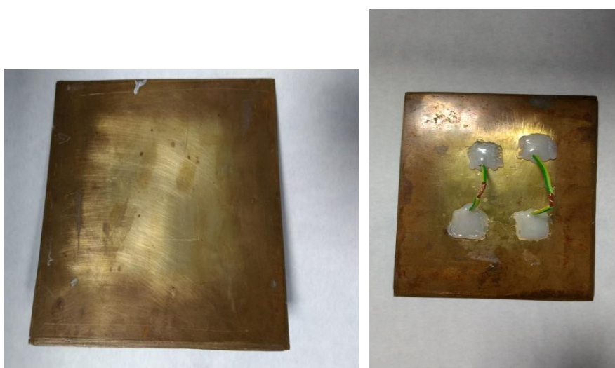
Figura 28. Imagen de la parte delantera y trasera de la placa metálica en el montaje del colector para el proceso de electrospinning .
