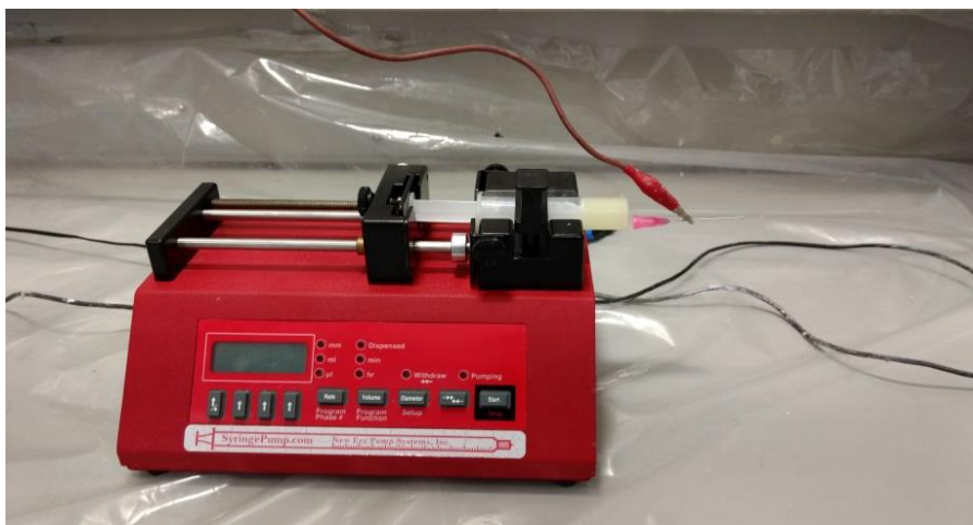
Figura 30. Montaje del ánodo para el proceso de electrospinning .
