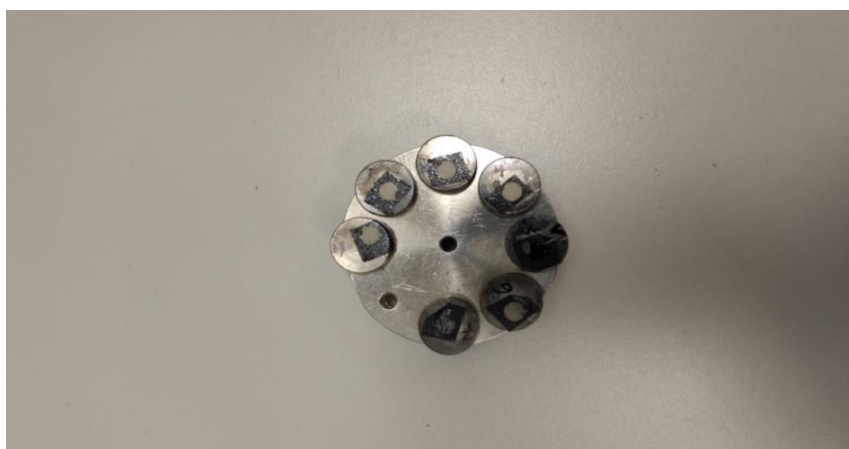
Figura 34. Imagen del soporte con los portamuestras tras la preparación inicial de las muestras para su caracterización mediante microscopía SEM
