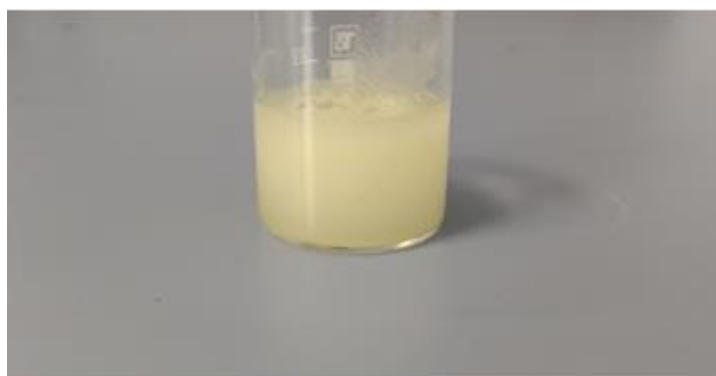
Figura 24. Imagen de la emulsión después de tratamiento con sonicador
