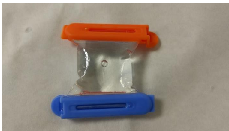
Figura 17. Ácido hialurónico modificado con tiramina en membrana de diálisis para su lavado.
