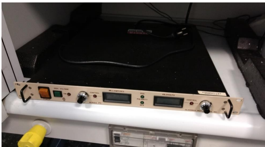
Figura 74. Imagen de la fuente de alimentación empleada en el procedimiento experimental para el proceso de electrospinning .
