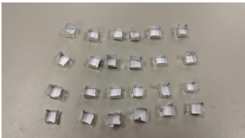
Figura 35. Soportes de 1cm x 1cm para el entrecruzamiento del hidrogel de ácido hialurónico modificado con tiramina con las membranas emulsionadas de electrospinning y con el film de solvent casting .
