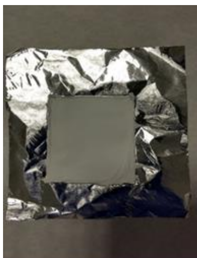
Figura 33. Membrana final obtenida en el proceso de electrospinning
