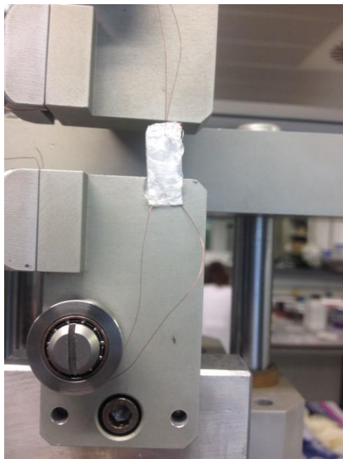
Figura 38. Preparación inicial de las muestras para el ensayo de resistencia al desgarro en la máquina de ensayos Microtest.
