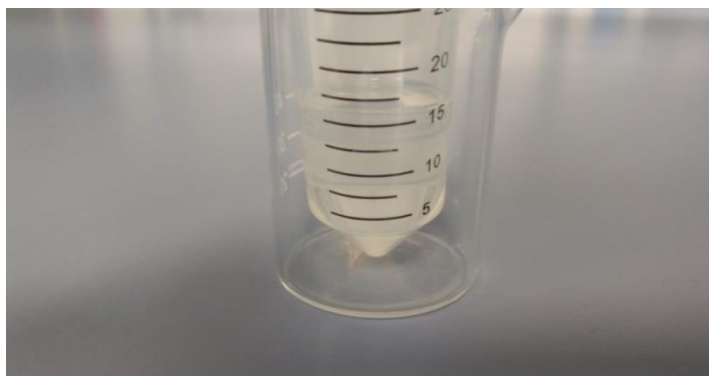
Figura 21. Fase polimérica de la emulsión formada por 16 mL de ácido poliláctico con una concentración del 7% disuelto en una disolución de cloroformo (75%) y acetona (25%)
