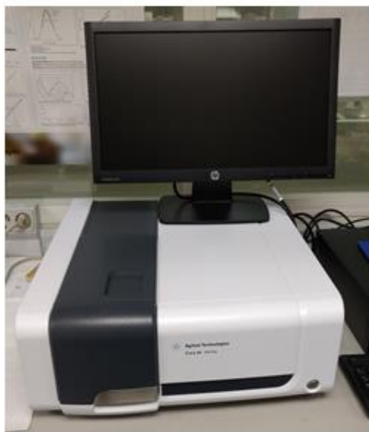
Figura 71. Imagen de espectrofotómetro empleado en el procedimiento experimental para la determinación del grado de reticulación y el estudio de la liberación de fármaco.
