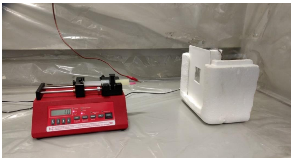
Figura 32. Montaje completo del proceso de electrospinning
