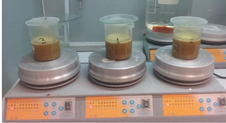
Figura 7. Digestión ácida en vaso abierto.
