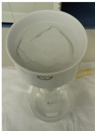
Figura 12. Precipitado gelatinoso de silicatos y boratos.
