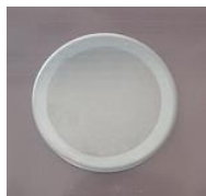
Figura 23. Fuente radiactiva final tras la limpieza con acetona (plancheta de acero).
