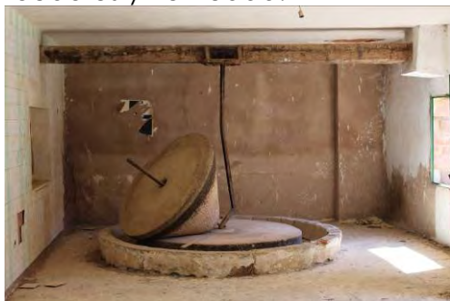
Fig. 271. Muela para aceite que todavía se conserva en la Masía de la Garrofera de Marines.
