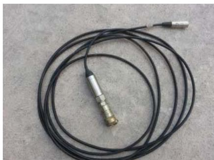
Figura IV.31: Transductor de carga
