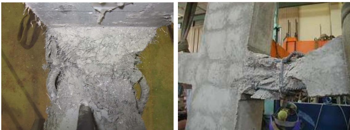
*Figura I.1 Pandeo en la armadura comprimida*
