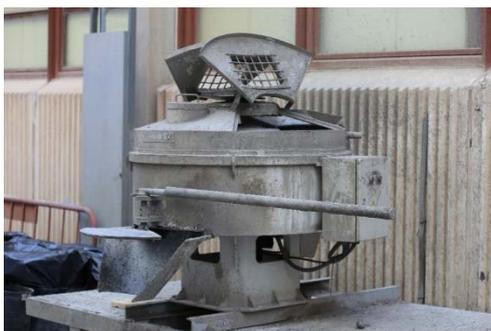
*Figura IV.42: Turbo mezcladora de eje vertical*
