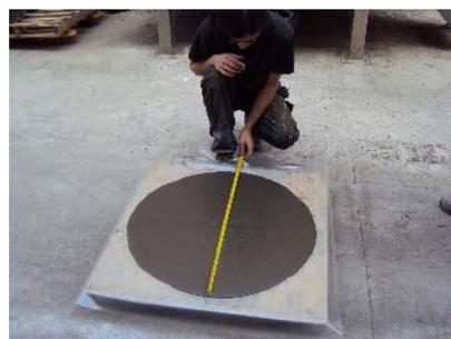
Figura IV.57: Medición del diámetro del círculo de hormigón
