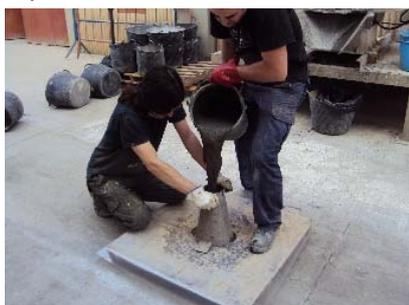
Figura IV.56: Preparación ensayo de escurrimiento
