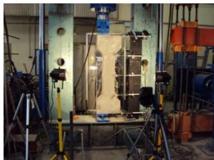
Figura IV.36: Montaje del soporte gráfico
