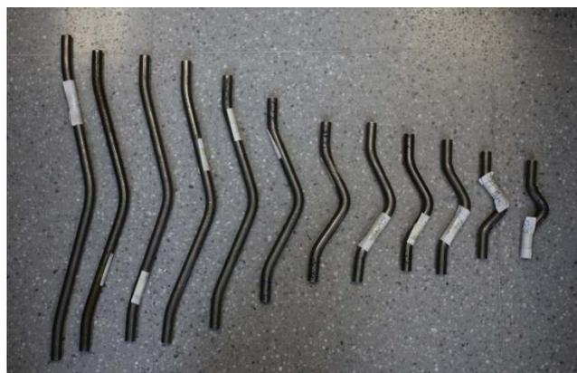
Figura VI.6: Relación de barras de acero ensayadas
