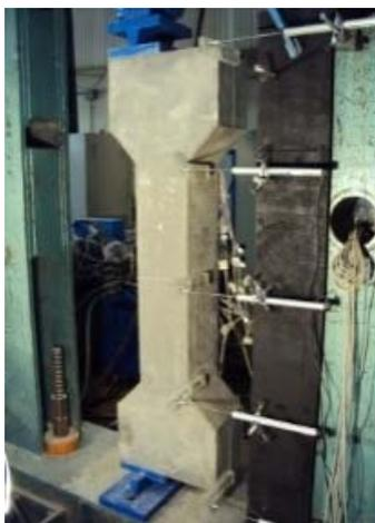
Figura IV.29: Transductores de desplazamiento
