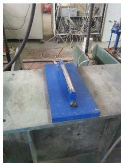
Figura IV.39: Placas de apoyo inferior y superior
