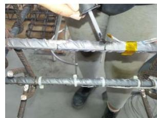
Figura IV.15: Aplicación del adhesivo
