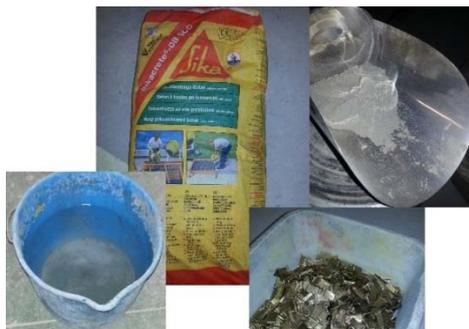
Figura IV.51: Material preparado para el caso de hormigón de resistencia normal
