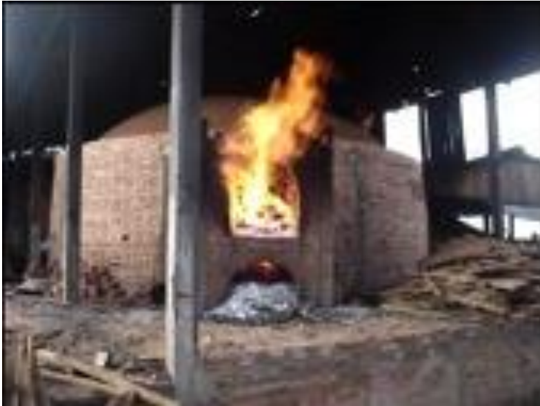
Figura 6: Registro dos riscos acidentais e desconforto térmico, proveniente da combustão de insumos madeireiros em fornalha de forno tipo abóboda
