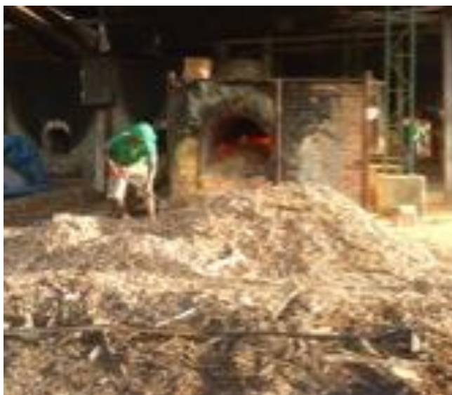
Figura 7: Registro fotográfico de um operador de forno abóboda em processo de levantamento de carga de insumos combustíveis
