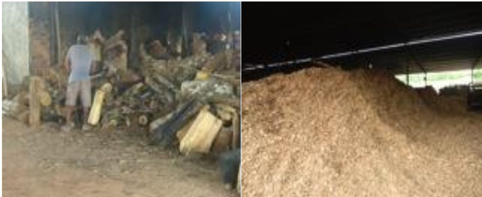
Figura 3 e 4: Utilização de lenha nativa e cavaco como combustível, para a queima na produção de tijolos
