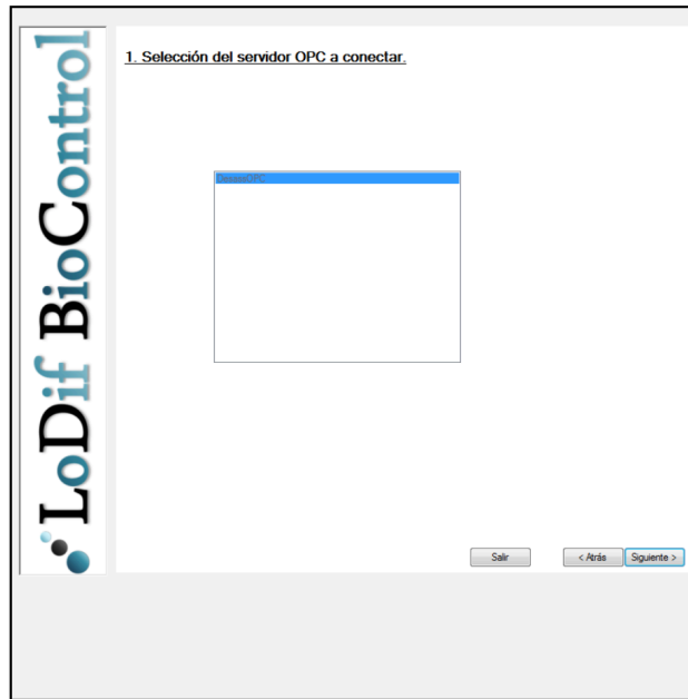
Figura 41: Ventana de selección del servidor OPC a utilizar para la conexión de LoDif BioControl con la EDAR real o virtual.
