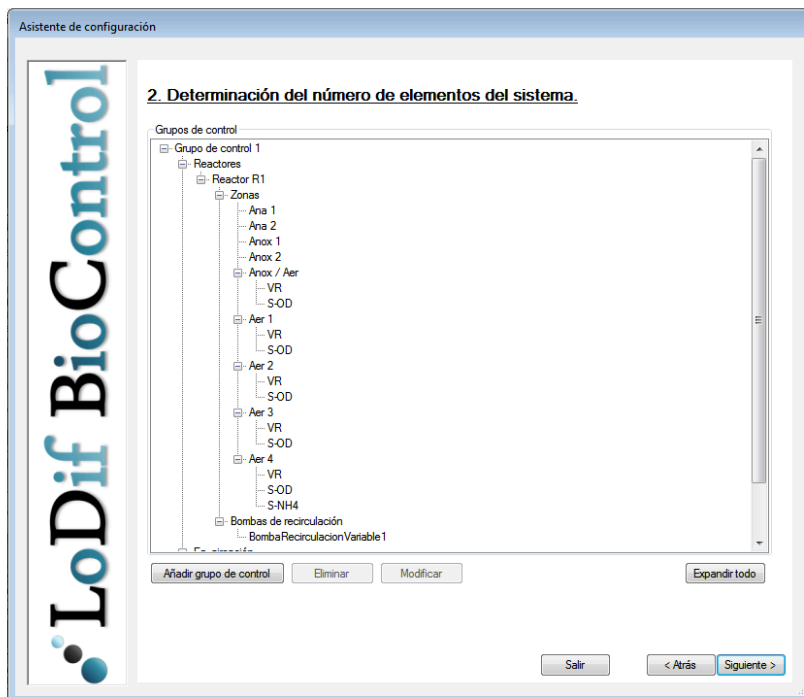
Figura 42: Ventana de selección de los grupos de control del sistema en LoDif BioControl.
