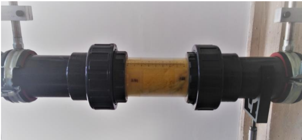
Figura 37: Portamuestras montado en el banco de ensayos UPV
