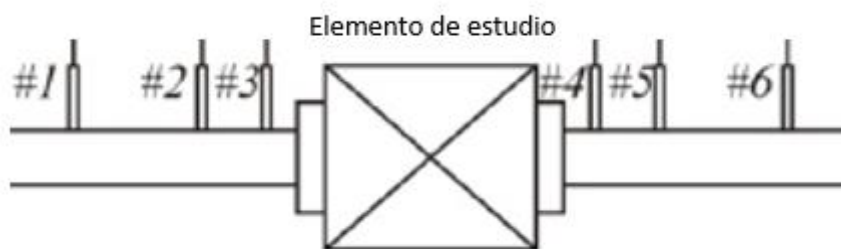
Figura 22: Montaje de micrófonos del banco de ensayos
