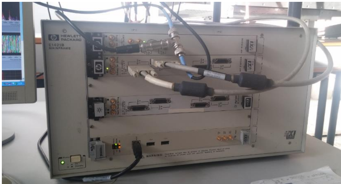
Figura 16: Sistema de adquisición/generación del banco de ensayos UPV
