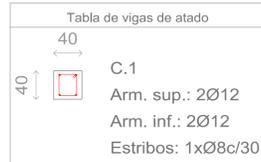
Detalle tipo: Viga de atado entre dos zapatas asiladas
