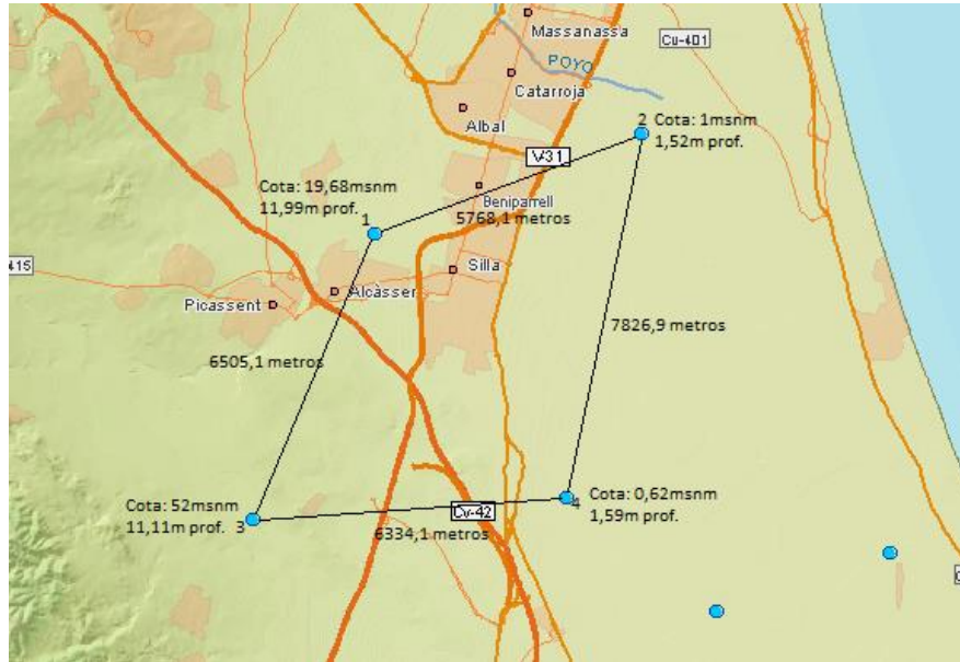
Imagen 19. Cotas, profundidad y distancias entre piezómetros de la zona. Fuente: Redes de seguimiento del Estado. Elaboración propia.
