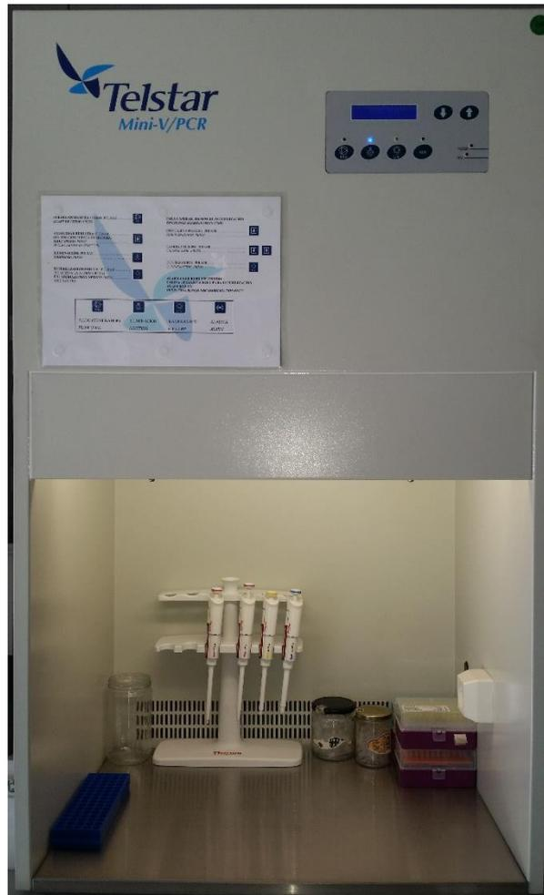
Figura 9. Cabina de flujo laminar vertical Telstar Mini-V/PCR.
