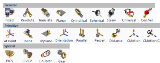
Figura 2.8: Subentorno Joint en RecurDyn
