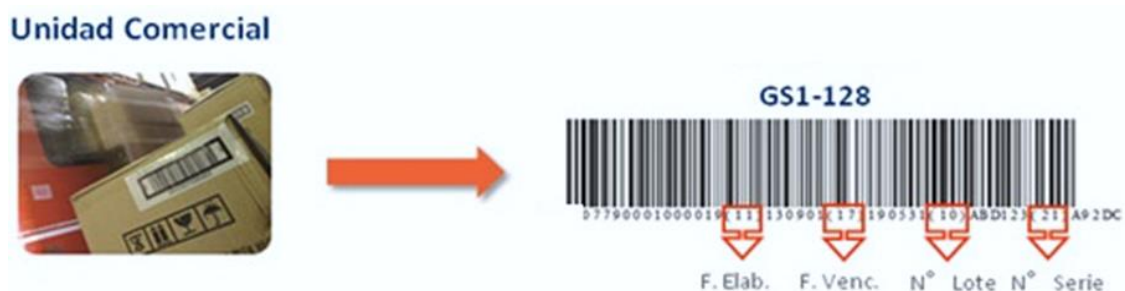
Figura 19. Ejemplificación del GS1-128 utilizado para la identificación de producto.
