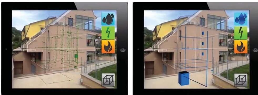
Imagen 70. 3D Tracker visualización de las infraestructuras del edificio utilizando un dispositivo móvil.
