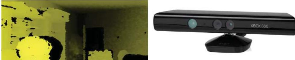
Imagen 41. Mapa de profundidad de *Kinect* y dispositivo *Kinect*.
