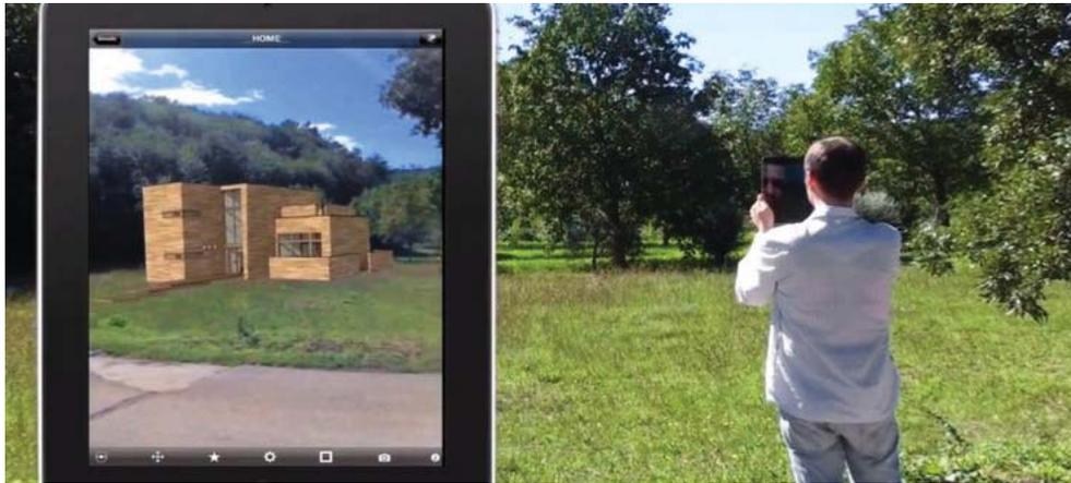
Imagen 69. AR-Media-plug-in visualización de los modelos 3D en el entorno real utilizando un dispositivo móvil.
