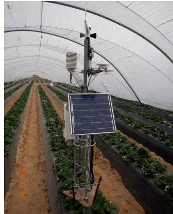
Figura 3. Estación meteorológica instalada dentro de un invernadero del tipo macrotúnel con cultivo de fresa.
