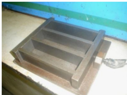
Figura 4.18 Molde de acero para las probetas prismáticas - EN 196-1
