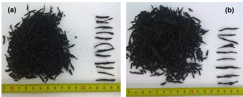
Figura 4.7 Fibra de neumático usada en la fabricación de los morteros. (a) Fibra de turismo FT (25 mm) - (b) fibra de camión FC (30mm)
