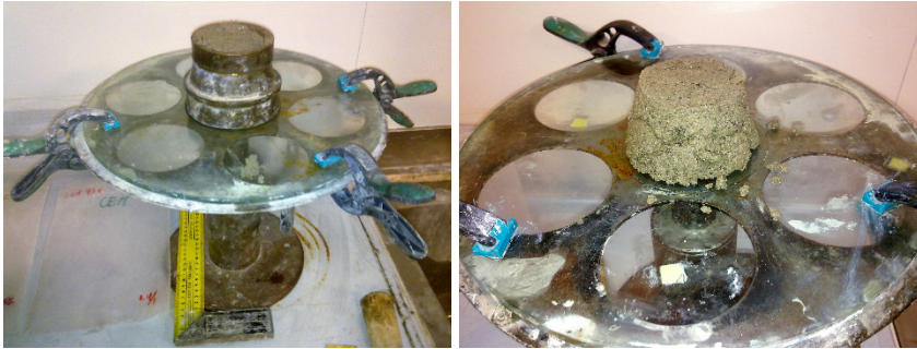
Figura 4.29 Mesa de sacudidas y molde de latón EN 1015-3 - Mortero antes de las sacudidas
