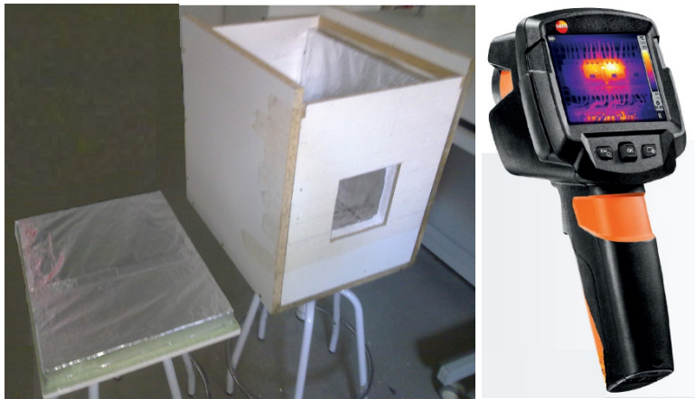
Figura 4.37 Caja aislada térmicamente - cámara termográfica
