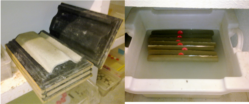
Figura 4.26 Curado de tejas encamara húmeda
