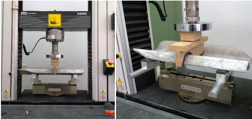
Figura 4.31 Piezas y ensayo de resistencia a flexión transversal
