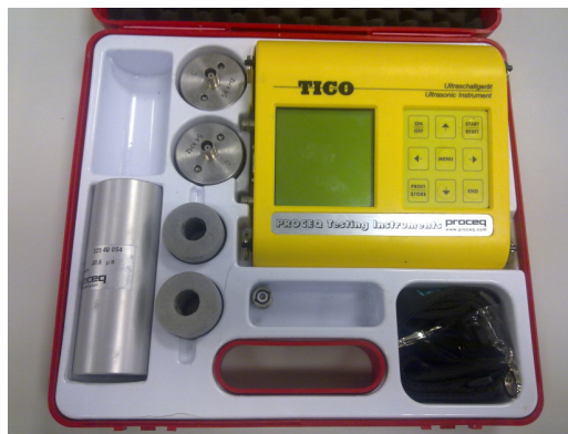
Figura 4.33 Equipo de medición de tiempo de transmisión de ultrasonidos
