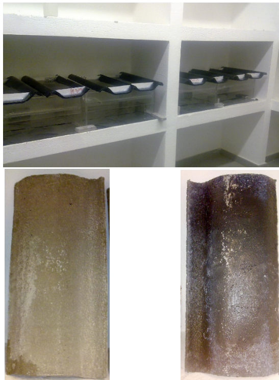
Figura 5.104 (arriba) Tejas de FCC en ensayo de impermeabilidad dentro de la cámara húmeda. (abajo) tejas de CP y SC vistas por el lado posterior mostrando que no hay presencia alguna de humedad ni filtración de agua.
