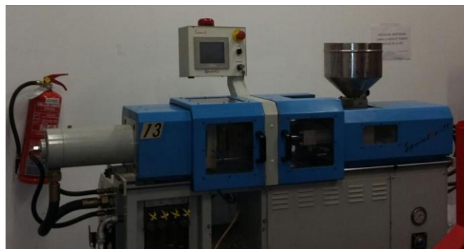
Figura 27. Equipo de inyección
