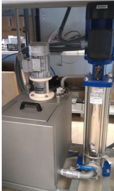
**Figura 3** – Agitador de partículas y bomba centrífuga
