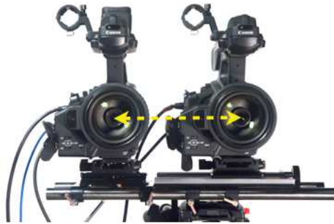
Figura 2.1. Separación interaxial en cámara estereoscópica [1]
