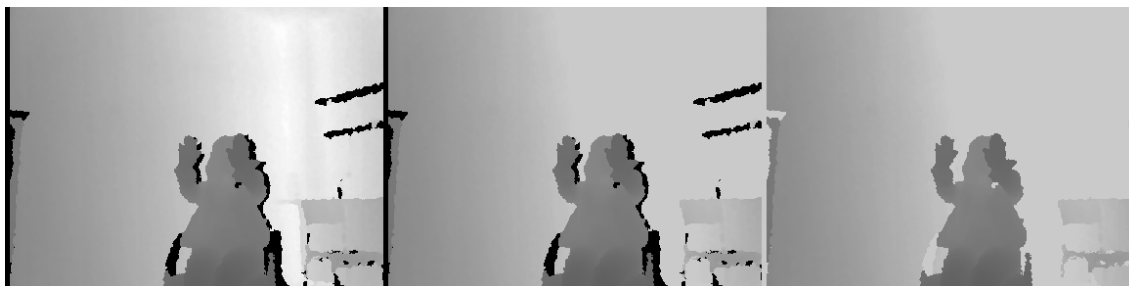
Figura 5.4. Imagen de distancias original (izquierda), imagen de distancias acotada en máximos (centro), imagen de distancias corregida (derecha)
