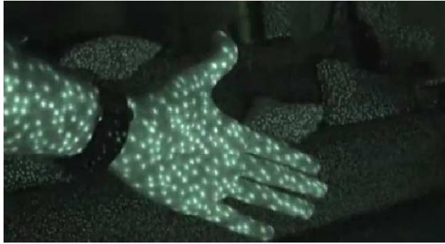
Figura 3.3. Patrón de puntos proyectado por cámara infrarroja , observado mediante una cámara de visión nocturna, es el tipo de patrón que proyecta la cámara utilizada para el proyecto[12].
