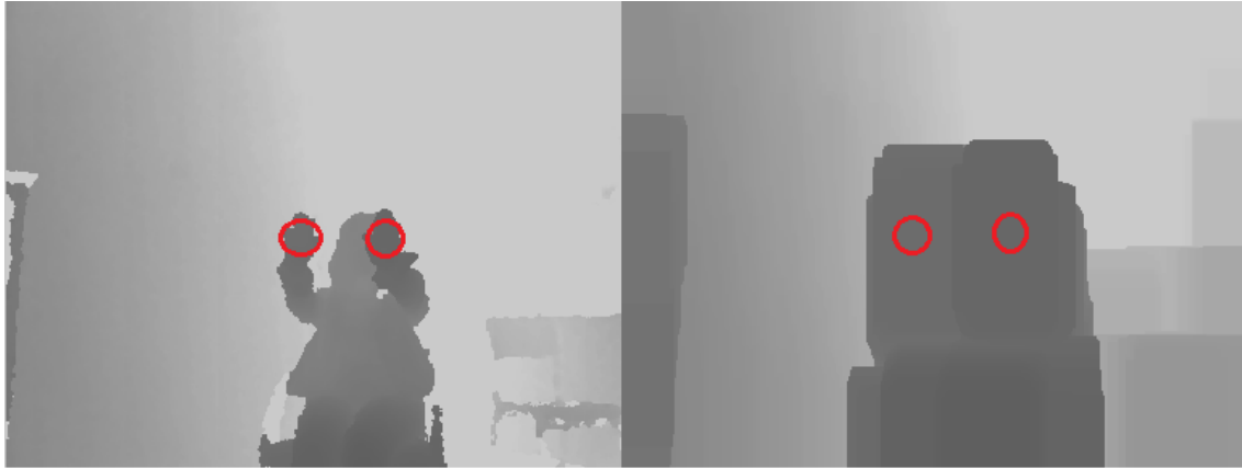
Figura 5.5. (Izquierda) Imagen distancias con las manos señaladas mediante círculos rojos, (derecha) Resultado de la erosión de la imagen de distancias, se marcan los puntos correspondientes al lugar donde están las manos, se observa que el esparcimiento de las zona más oscuras que corresponden a las manos.
