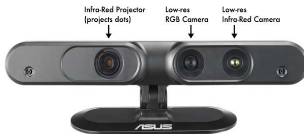
Figura 3.2. Cámara Asus Xtion Pro live, con sus componentes principales señalados [12]
