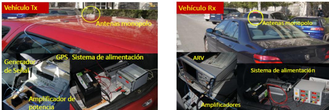
Figura 5.2: Vehículos tx y rx con el equipamiento a bordo [27]
