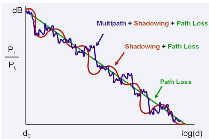
Figura 4.5: Efectos de la propagación en un canal de banda estrecha [29]
