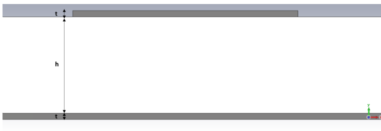
Figura 4.6: Línea microstrip (perfil)
