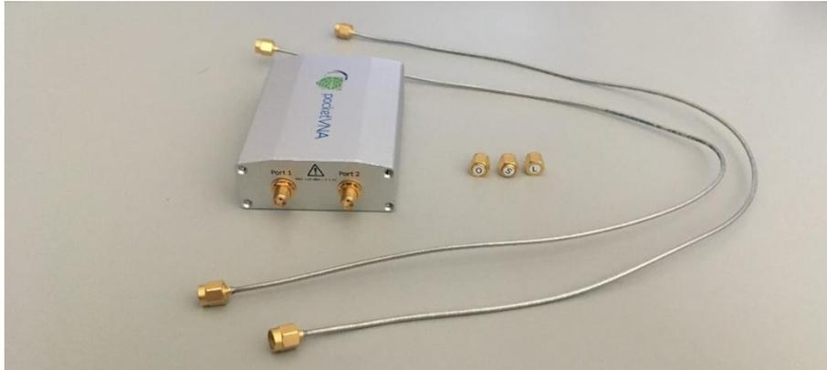
Figura 14. PocketVNA, kit de calibración y cables.
