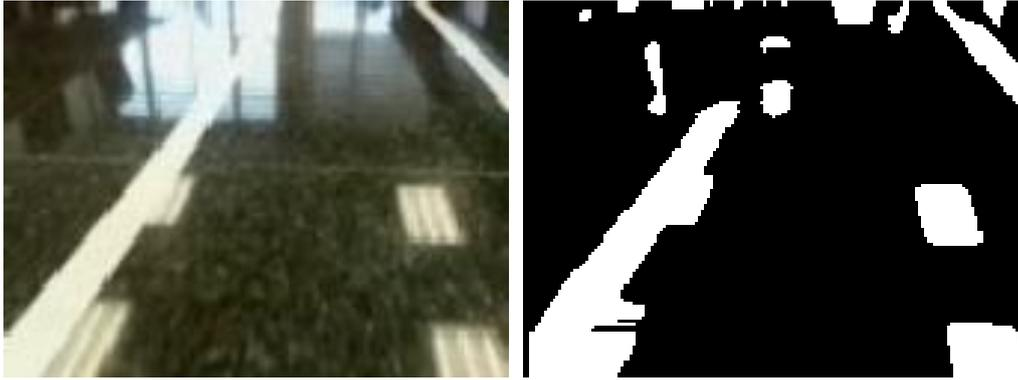
Fig. 72. Imagen con reflejos adheridos a la línea blanca. (a) Imagen captada. (b) Imagen binarizada.
