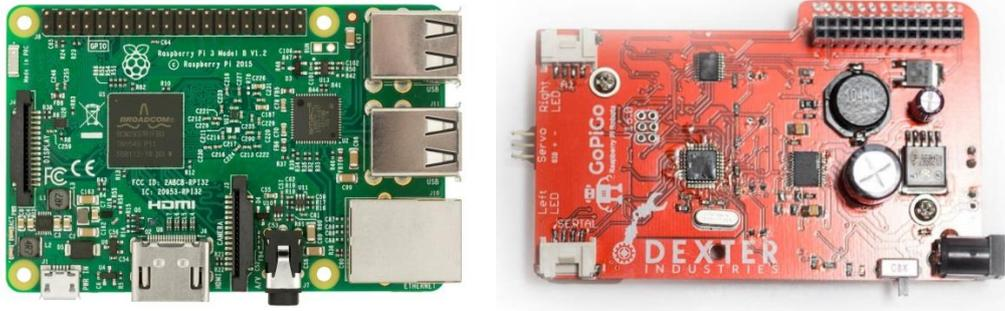
Fig. 7. Placas del GoPiGo. (a) Raspberry-Pi. (b) GoPiGo 2 (Arduino).
