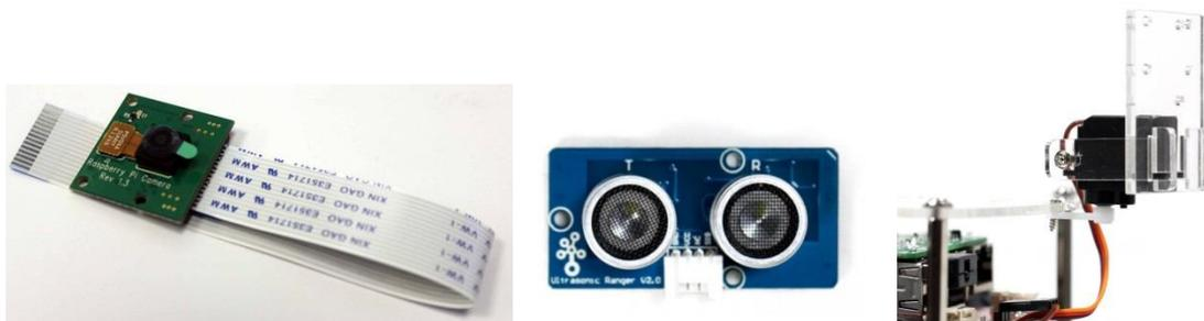
Fig. 6. Dispositivos del GoPiGo. (a) Cámara. (b) Sensor de ultrasonidos. (c) Servo móvil.
