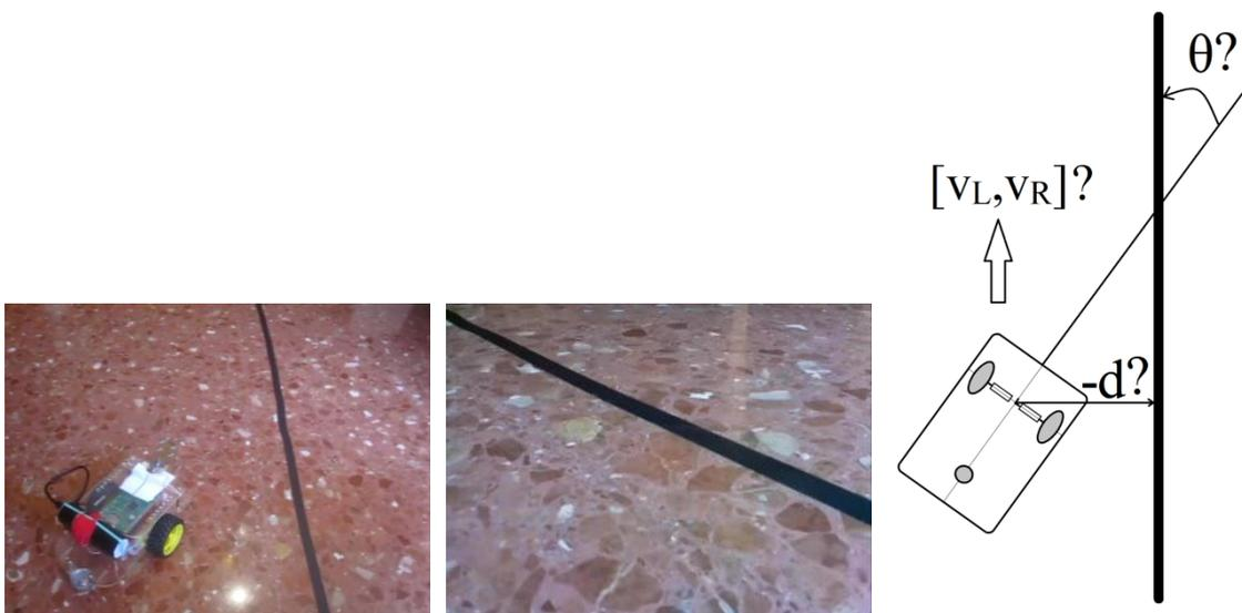
Fig. 11. (a). Foto en 3<sup>era</sup> persona. (b) Imagen captada. (c) Estado y velocidad del unicycle a calcular.
