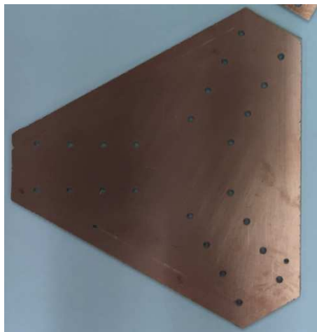
Figura 4.4: Vista en planta de la capa 1 del divisor después de ser cortada.
