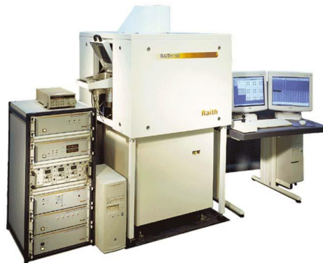
Fig. 56. Máquina Raith150 utilizada para la litografía por electrones. Tomada de J. Martí, Nanofabricación 28 .
