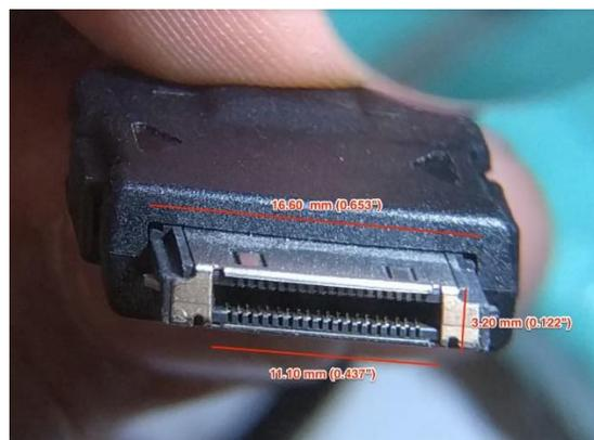
Figura 10. Conector DD2 utilizado por las Epson Moverio BT-100.
