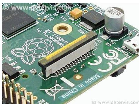
Figura 8. Conector DSI de la Raspberry Pi.
