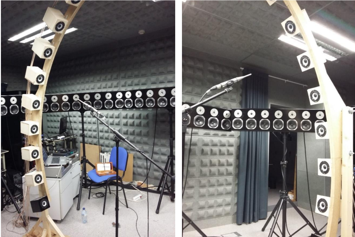
Fig. 32. Medida de la respuesta de los altavoces
