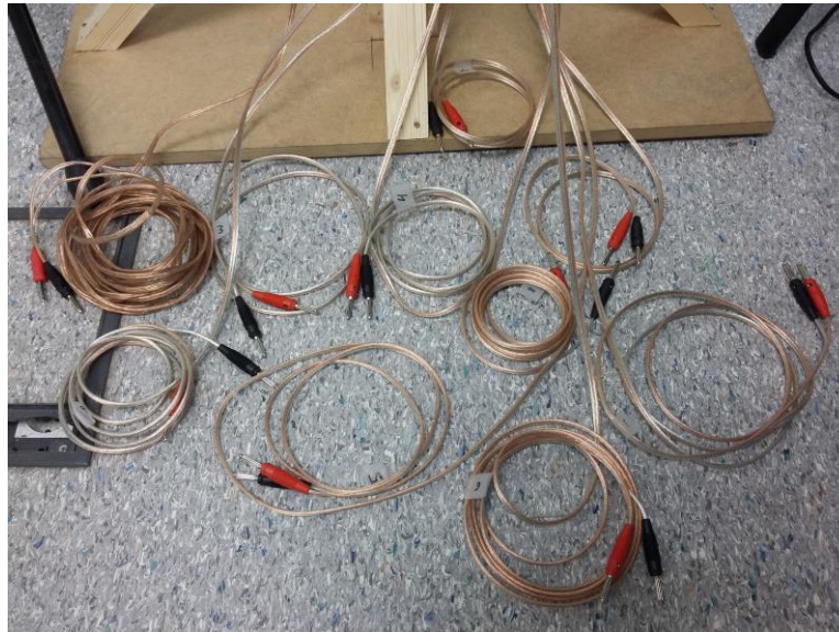
Fig. 18. Cables de pares finalizados con conectores banana
