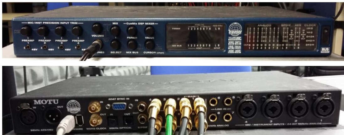
Fig. 21. Arriba: Panel delantero de la interfaz con la salida phones conectada Abajo: Panel trasero de la interfaz con ocho salidas Jack conectadas
