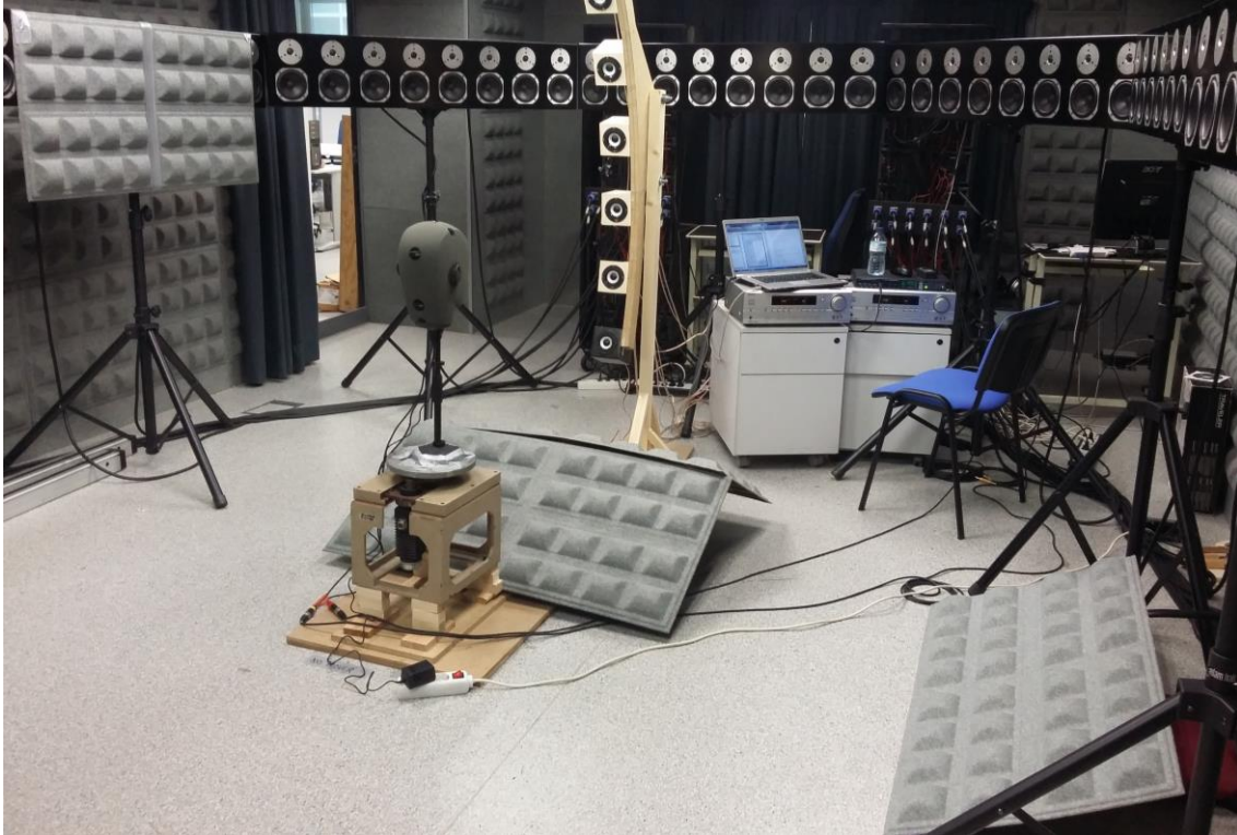
Fig. 29. Paneles absorbentes situados en el suelo y en la pared más cercana a la cabeza
