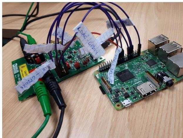
**Figura 62 - Conexión Raspberry Pi y Evalboard**
