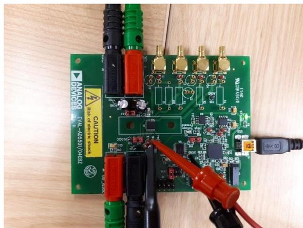
**Figura 57 - Sondas para medir CLK y trama de datos en Evalboard**
