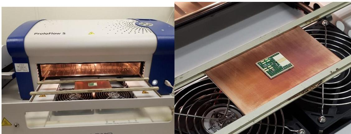
**Figura 71 – Horno de soldadura (izquierda) y circuito del primer circuito sobre ventiladores para el proceso de enfriamiento (derecha)**
