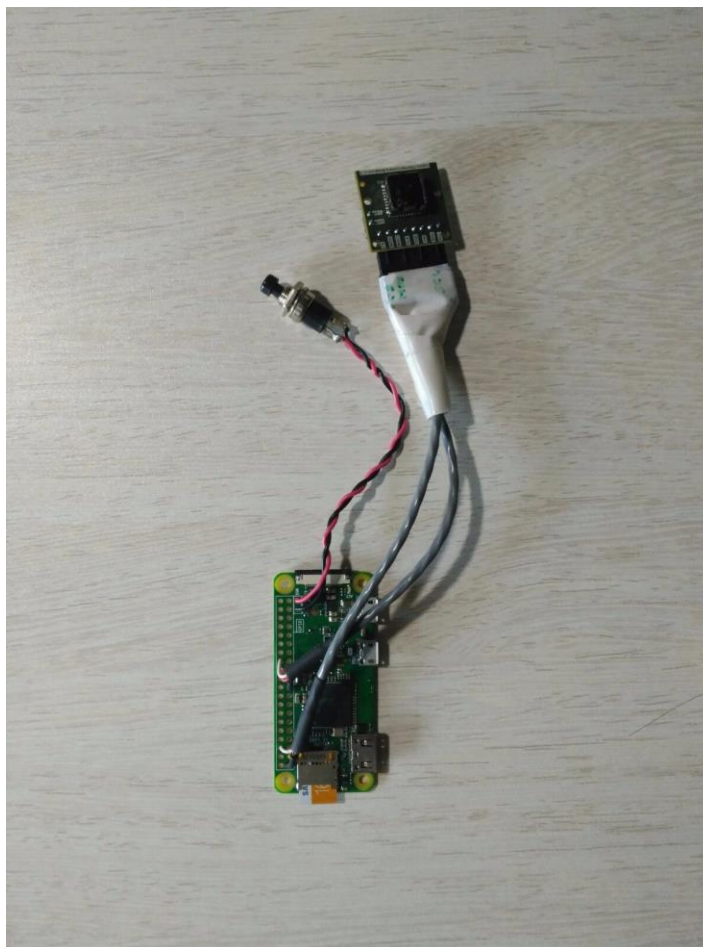
Figura 5 Parte back-end: Raspberry Pi Zero y cámara Lepton FLiR
