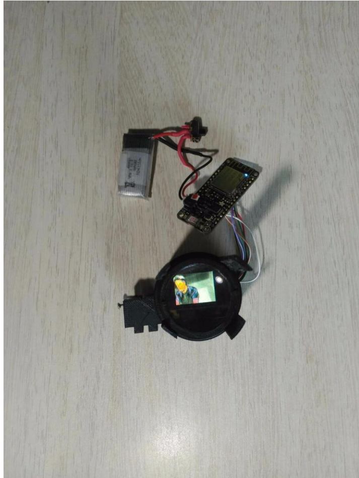
Figura 6 Parte front-end: NodeMCU Firmware y display SSD1331
