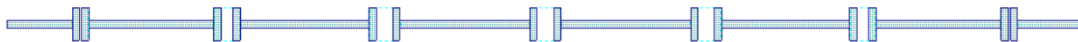
Figura 44. Layout del modelo circuital de gaps para N=6 , RL=15 dB y \mathcal{W}=0.02 .
