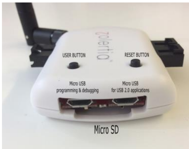
Figura 36. Esquema de los diferentes puertos y botones del RE-Mote [34].
